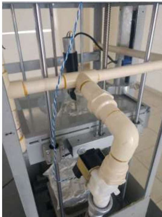
Figura 69. Ductos de entrada sistema de enfriamiento.
