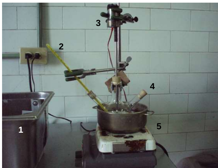
Figura 22. Reacción polimérica de PAN: control térmico manual reportado por Dena-Aguilar et al.
