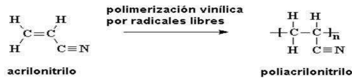
Figura 2. Representación de la polimerización por radicales libres del PAN. 8
