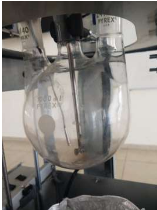
Figura 61. Acercamiento interior de reactor: agitador y sensor
