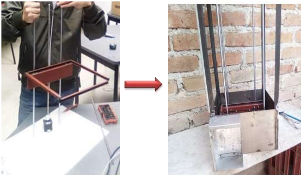
Figura 50. Ensamblado y puesta de la plataforma elevadiza.
