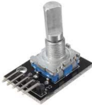
Figura 11. Potenciómetro KY-040 Encoder Rotatorio (fuente: electrocrea.com).
