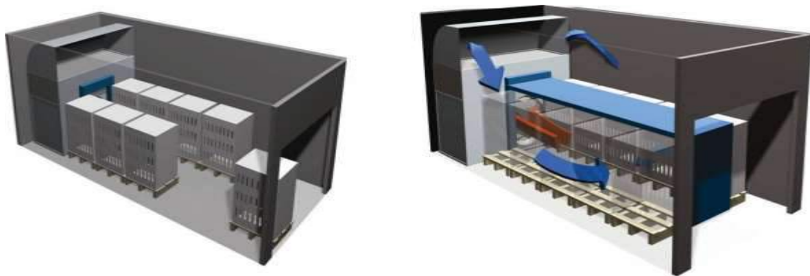
Figura 7. Túneles de pre enfriamiento por aire forzado (fuente: mundohvacr.com.mx).
