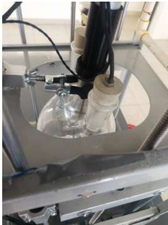
Figura 59. Acercamiento parte superior de reactor: soporte de motor de agitación y entrada sensor de temperatura.
