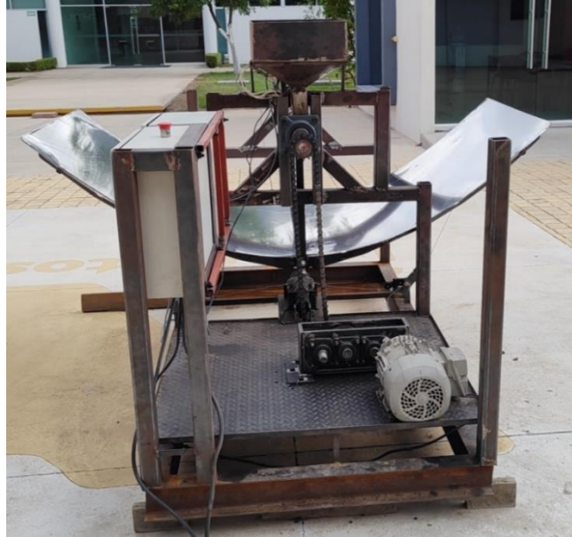
Figura 50. Vista posterior del sistema de concentración y seguimiento solar instalado en el prototipo.
