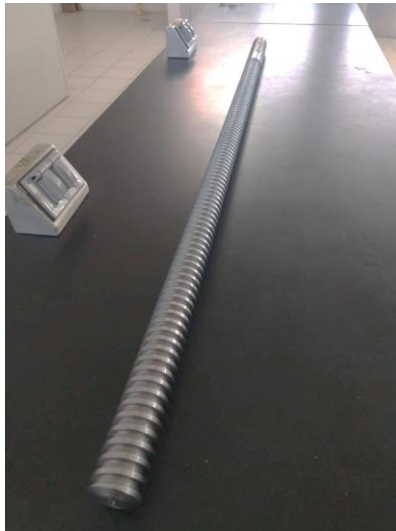
Figura 29. Vista completa del husillo con alabes maquinados [84].
