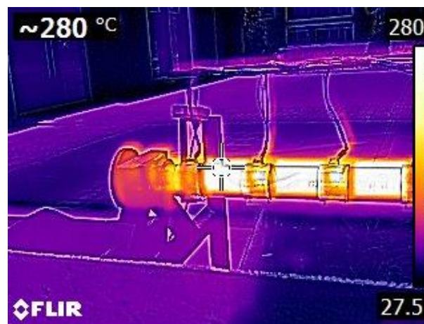
Figura 68. Lectura >280 °C de temperatura alcanzada en la superficie del barril (P4) con la acción del sistema de calentamiento hibrido. Prueba realizada en el mes de mayo de 2023.
