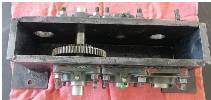
Figura 20. Preensamble de engranaje, ejes y chumaceras en la caja reductora.
