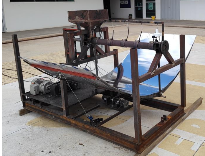
Figura 42. Montaje del CCP y el sistema mecánico de seguimiento solar en la máquina extrusora.
