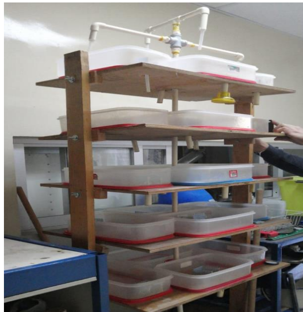
Figura 25.- Sistema hidropónico con un sistema de iluminación artificial tipo LED. a) Configuración de variables para el sistema de iluminación artificial. b) Rack hidropónico con 4 calidades de luz.
