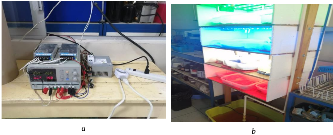
Figura 26.- Sistema hidropónico con un sistema de iluminación artificial tipo LED. a) Configuración de variables para el sistema de iluminación artificial. b) Rack hidropónico con 4 calidades de luz.
