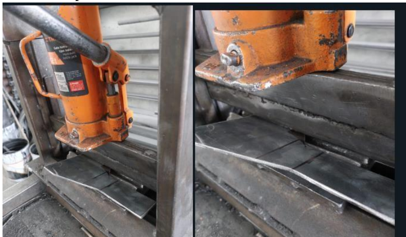
FIGURA 20 y 21: Doblado de pieza metálica
