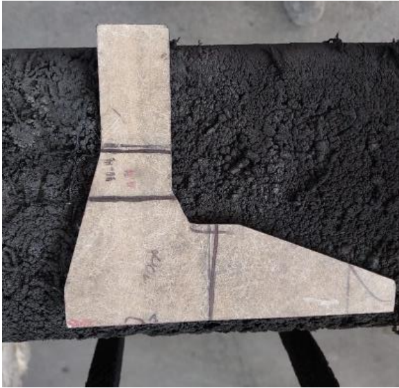
Figura 11: Plantilla de guía hembra para línea de cofre Mack.
