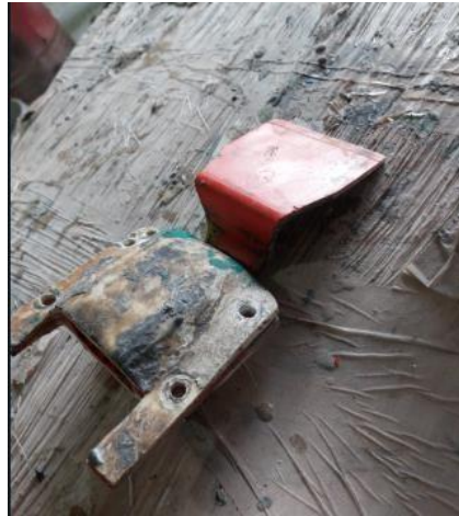
FIGURA 28: Molde 2, utilizado para rellenar pieza metálica.
