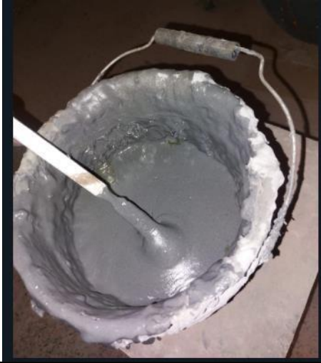
FIGURA 27: Resina compuesta por resina poliéster, fibra de vidrio molida y catalizador.
