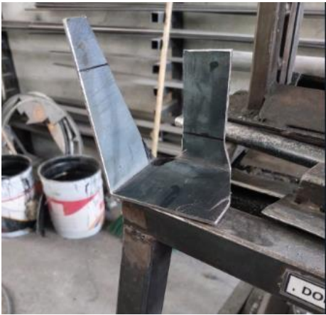
FIGURA 22: Rectificado de dobleces
