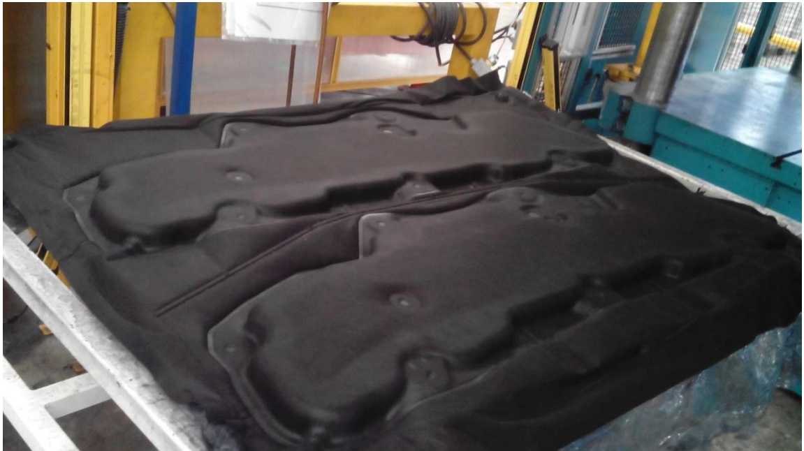
Figura 26. Pieza después del horno de conformado.
