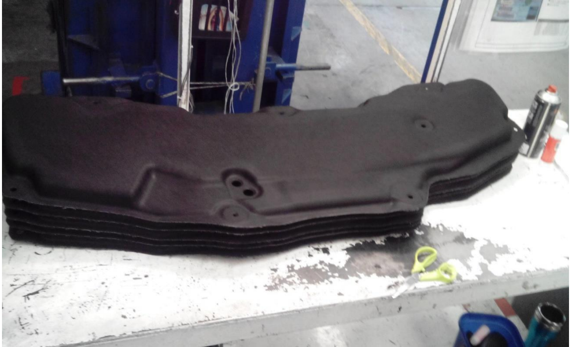
Figura 28. Pieza cortada después de la prensa.
