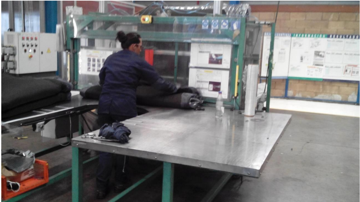
Figura 24. Cortes de tela con fibra de vidrio.
