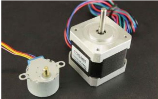
Ilustración 10 Motor a Pasos. Tomado de (GeekFactory, 2017)
