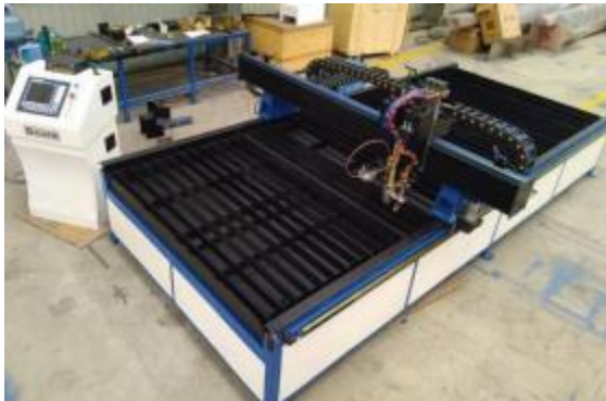
Ilustración 6 Cortadora de plasma CNC Marca Huafei. Tomado de (Huafei, 2020)
