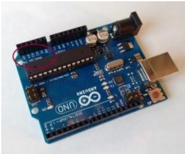
Ilustración 8 Entradas analógicas y digitales Arduino Uno. Tomado de (Perez, 2015)
