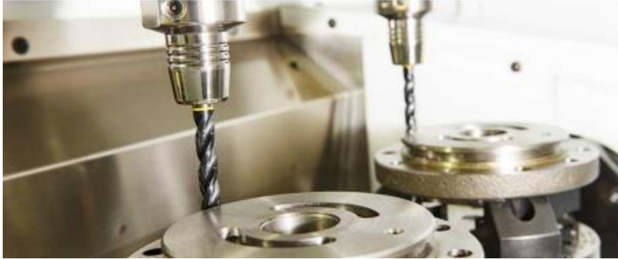
Ilustración 5 Taladrado CNC. Tomado de (Peng, 2021)
