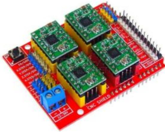
Ilustración 9 Uso de Arduino CNC Shield V3. Tomado de (Xukyo, 2023)
