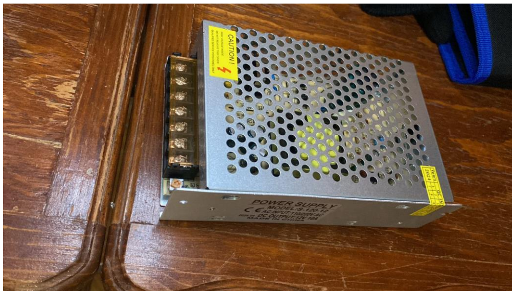
Ilustración 13 fuente de conmutada 12v 10a 120w Ronix 110/220vca
