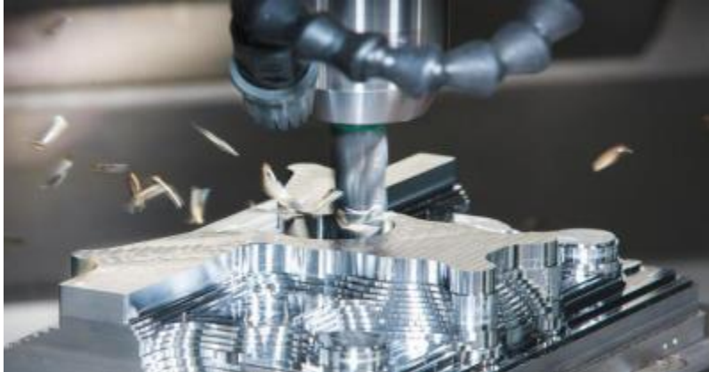
Ilustración 3 Fresadora CNC removiendo material. Tomado de (Viotto, 2022)
