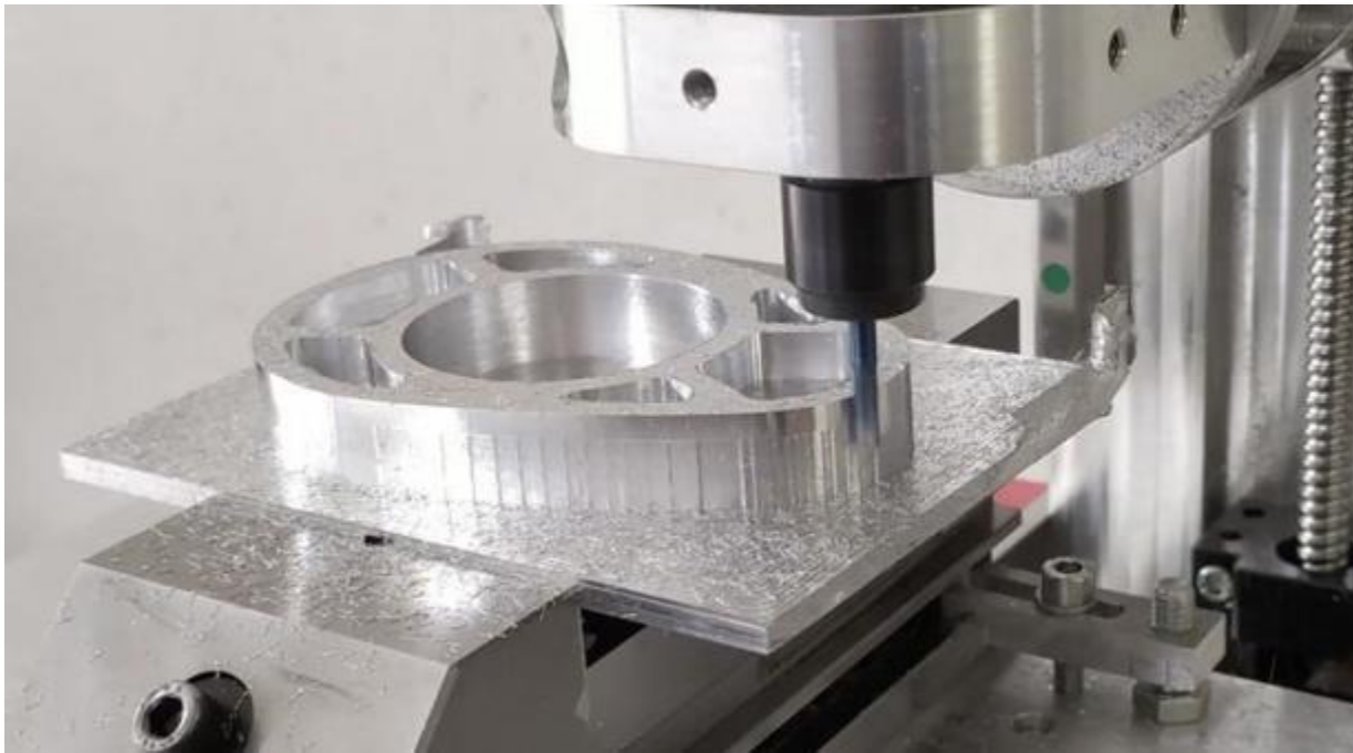
Ilustración 2 CNC fresadora de metales. Tomado de (Peng, 2021)
