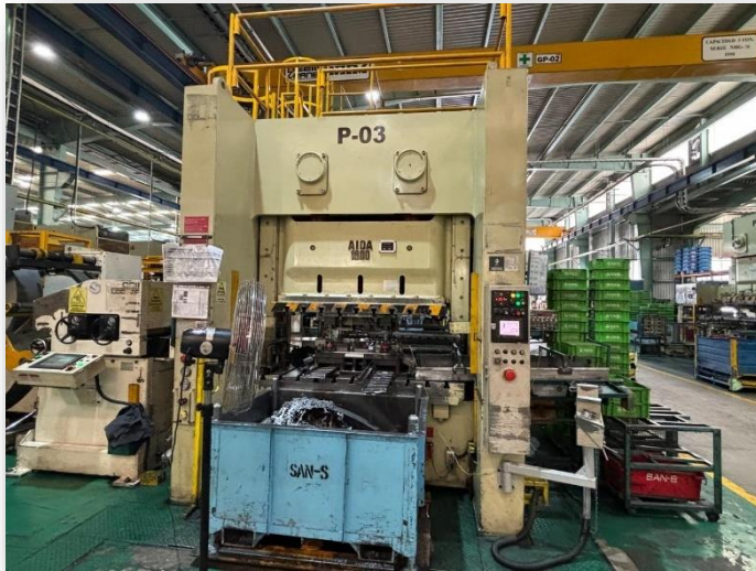
Figura 4.8 Prensa blanking y el tipo de plantilla que produce.
