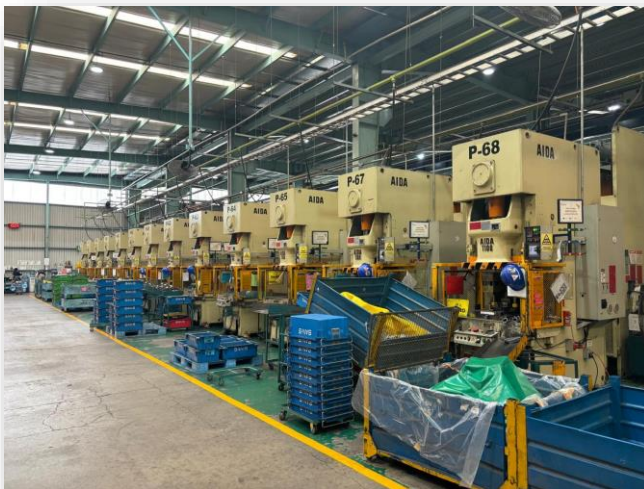
Figura 4.9 Prensas tándem y un ejemplo de las piezas terminadas que producen.
