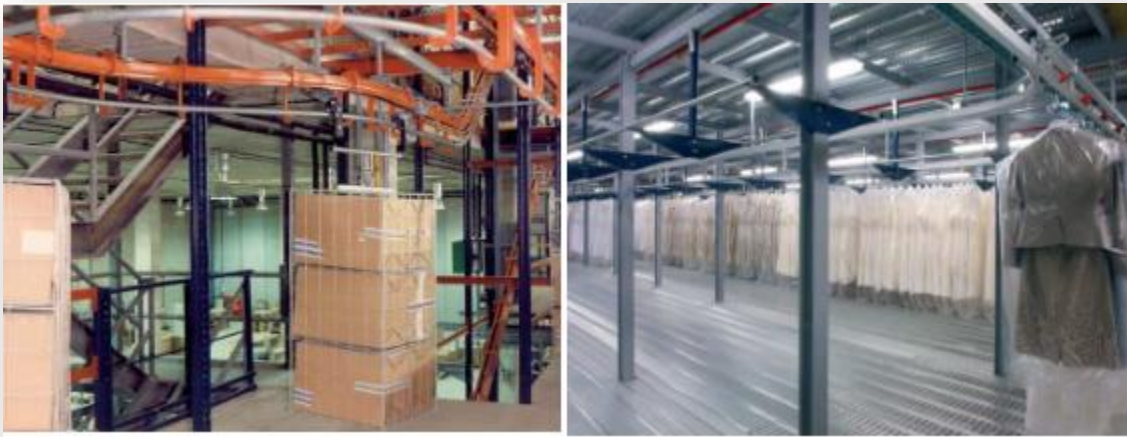
Figura 3.28 Tipos de transportadores aéreos usados en un almacén.
