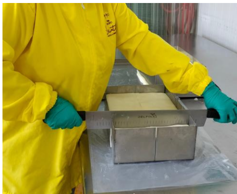
Ilustración 5. 10 Mecanismo de corte con cuchillo de doble mango. Fuente: propia 2024
