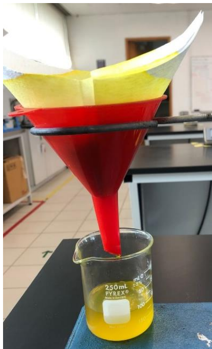
Figura 16. Hexano + aceite vegetal recuperado por filtro de poro medio. Vista 1.
