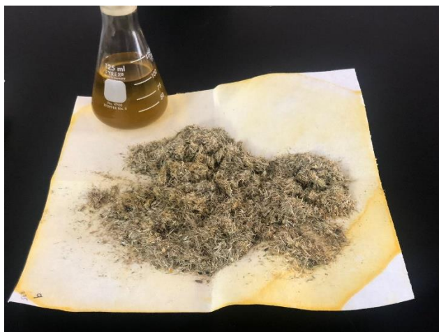
Figura 21. Semilla + hexano a utilizar en Soxhlet.
