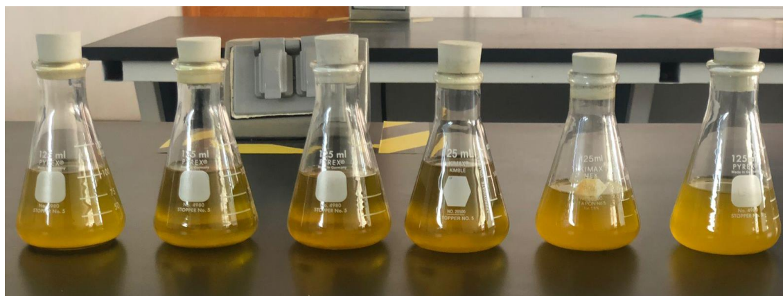
Figura 22. Hexano recuperado por porción para Soxhlet.
