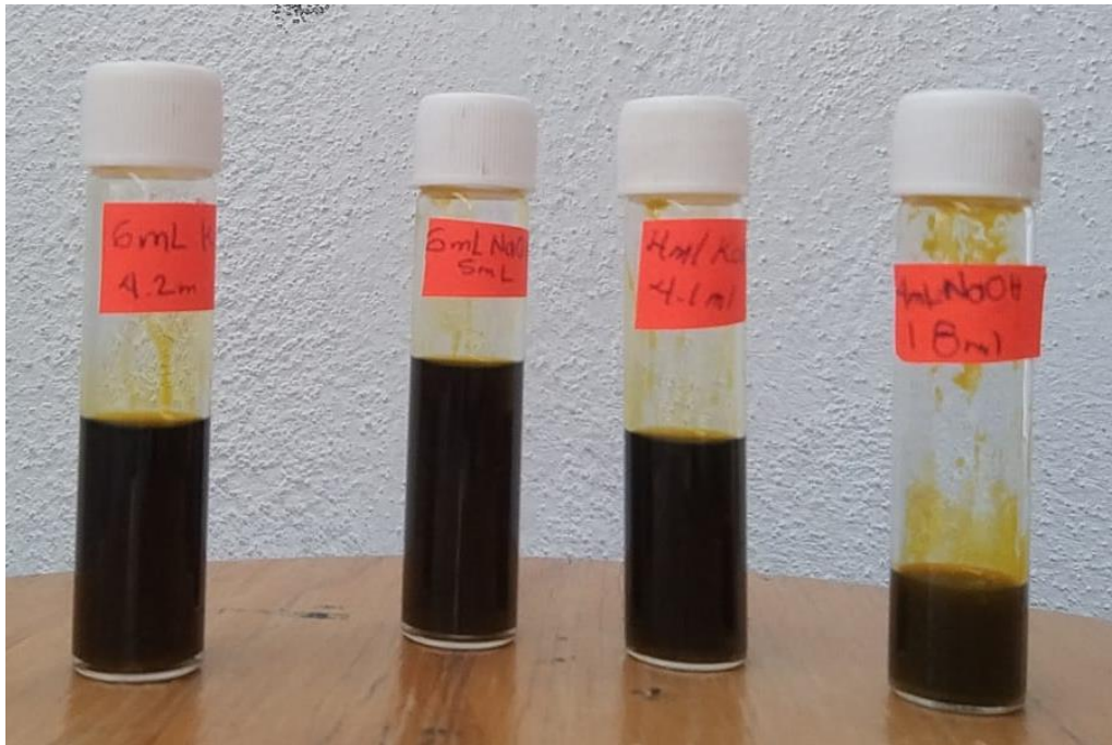
Figura 37. Muestras finales de biodiésel después de secado.
