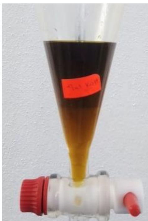
Figura 30. Muestra de separación de fases de 4 mL de KOH.
