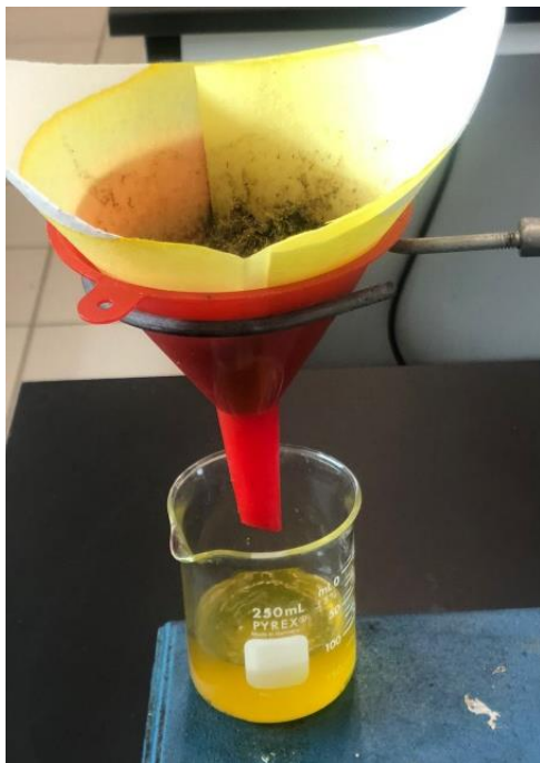
Figura 17. Hexano + aceite vegetal recuperado por filtro de poro medio. Vista 2.
