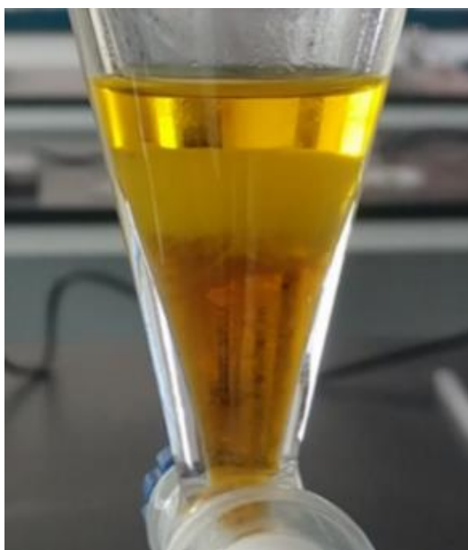
Figura 8. Biodiésel (capa superior) obtenido por [1] de la maleza Bidens ferulifolia (Jacq.) DC. (tomada de [1]).
