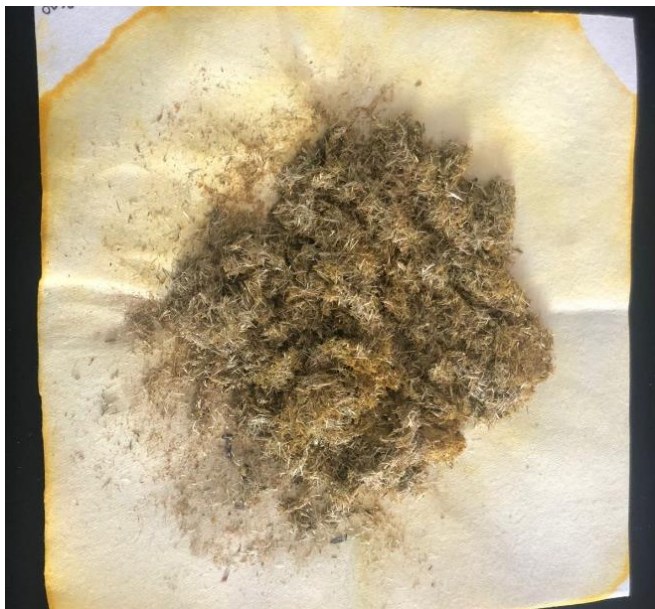
Figura 20. Semilla resultante después de secado en estufa y lista para poner en desecador.
