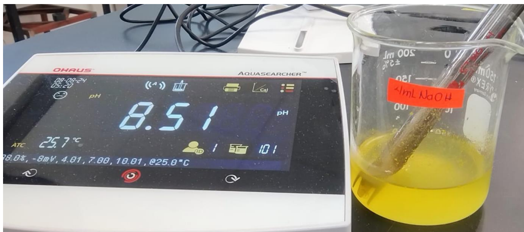
Figura 33. Toma de pH a residuo de primer lavado de 4 mL de NaOH.
