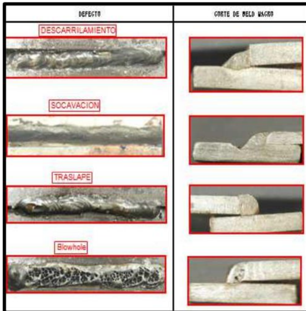
Ilustración 3. 5 Defectos de soldadura. Fuente: YMEX 2024
