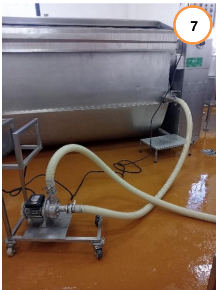
Figura 9. 2 Continuación: Escaldado, Reposo 1, Desuerado 1, Recepción de pasta en tina. Fuente: propia, 2024.
