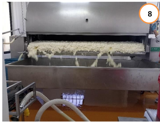
Figura 9. 2 Continuación: Escaldado, Reposo 1, Desuerado 1, Recepción de pasta en tina. Fuente: propia, 2024.
