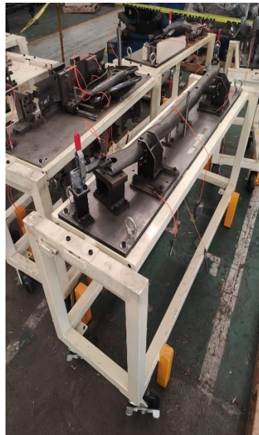
Imagen 5.6. Mesas de inspeccion para Jig's de calidad (Escantillones). Fuente: YMEX 2024
