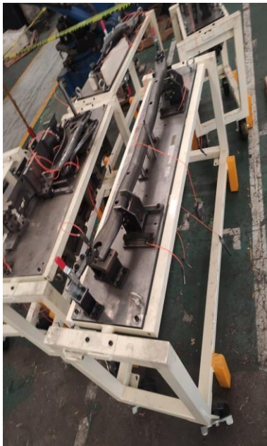
Imagen 5.6. Mesas de inspeccion para Jig's de calidad (Escantillones). Fuente: YMEX 2024
