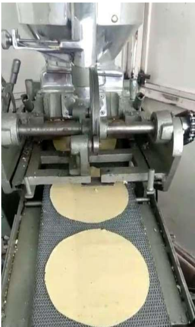
Imagen 4 Elaboración de Tortilla Tipo Torteada con Cabezal
