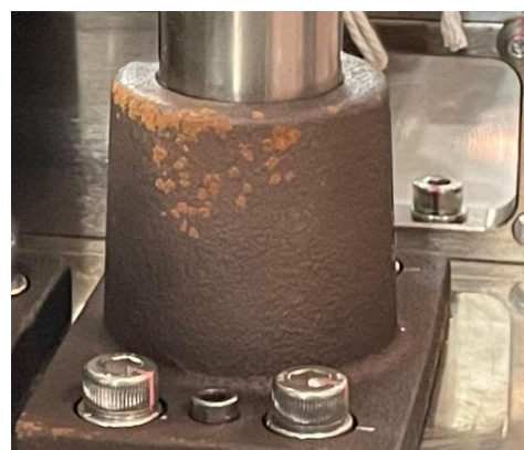
Ilustración 16 "Puntos atrapados en inspección - oxidación en componentes" (Fuente: Judd Wire, 2024)
