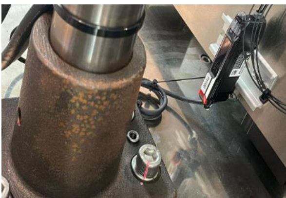
Ilustración 16 "Puntos atrapados en inspección - oxidación en componentes" (Fuente: Judd Wire, 2024)
