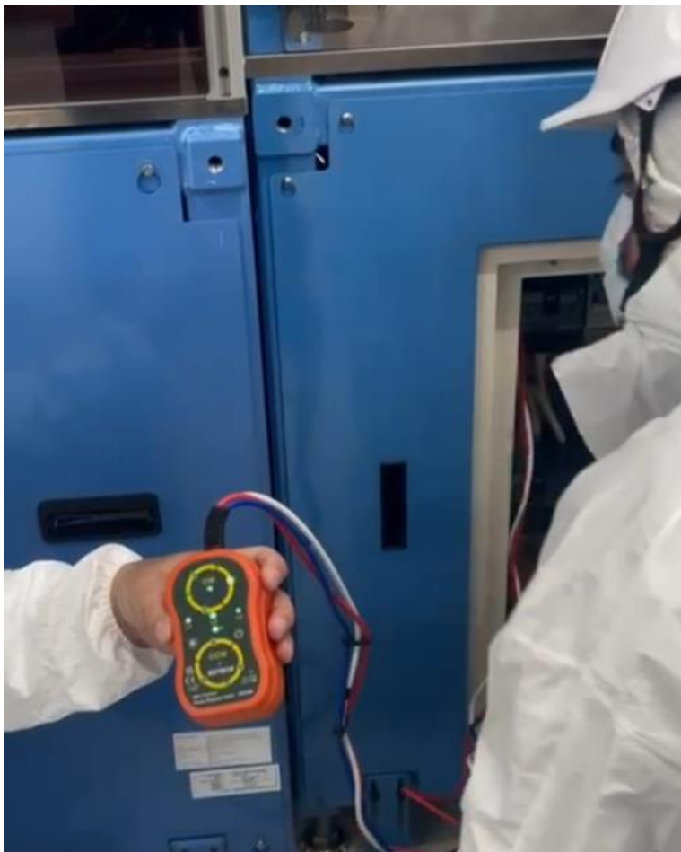
Ilustración 30 "Confirmación de fases - verificación" (Fuente: Judd Wire, 2024)
