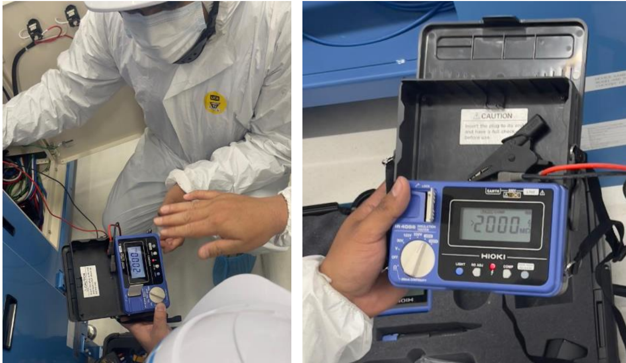
Ilustración 31 "Pruebas de resistencia del aislamiento" (Fuente: Judd Wire, 2024)
