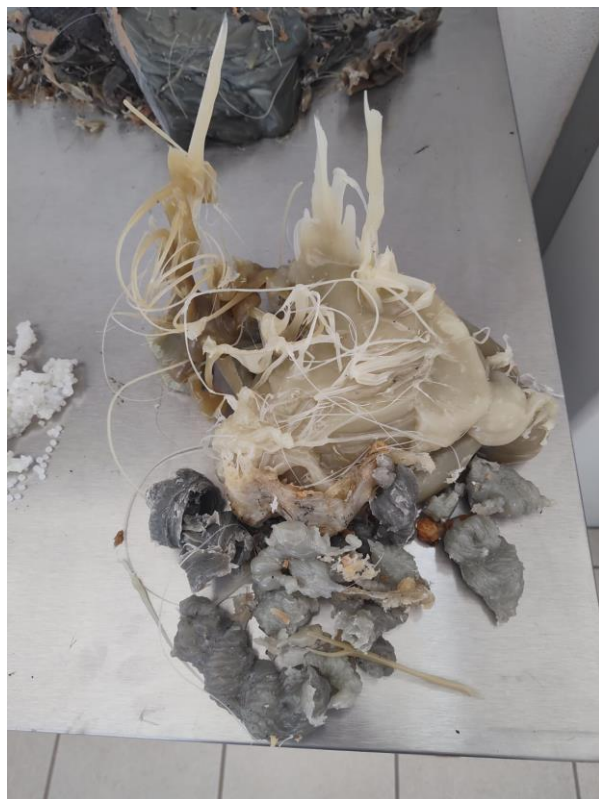
Figura 14. Aspecto “pata de elefante” del material extruido ya enfriado y resultante del proceso de la corrida 2-hibrida.
