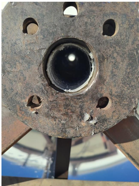
Figura 17. Aspecto de material de extrusión que se queda impregnado en las paredes internas del barril. El material no puede ser removido y su pesaje es diferenciado de la prueba inmediata siguiente de extrusión.
