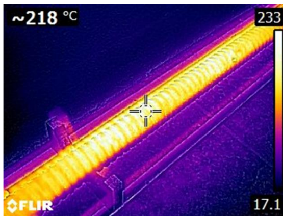
Figura 16. Temperatura del husillo recién retirado de la máquina extrusora y puesto a enfriamiento por convección natural.
