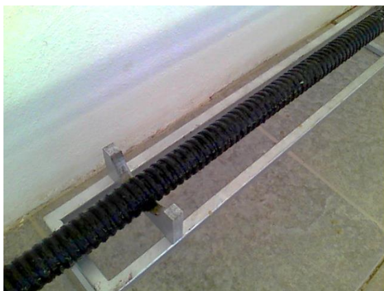
Figura 16. Temperatura del husillo recién retirado de la máquina extrusora y puesto a enfriamiento por convección natural.
