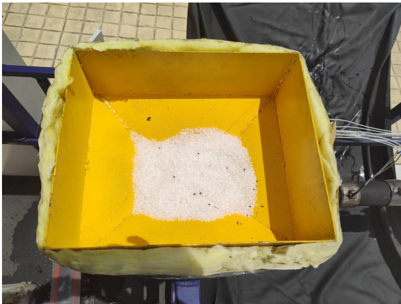
Figura 10. Material en tolva de alimentación del proceso de la corrida 3-eléctrica.
