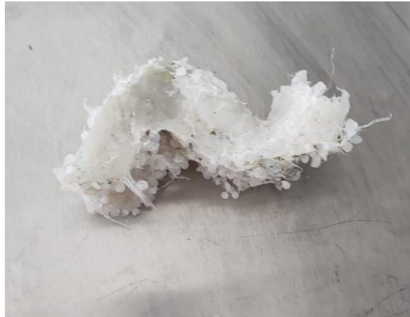
Figura 19. Aspecto de material de extrusión aglomerado que se queda impregnado en el cuello de la tolva de alimentación y en la entrada de la boca de acceso del barril. El material puede ser removido y su pesaje es caracterizado dentro de la prueba presente.
