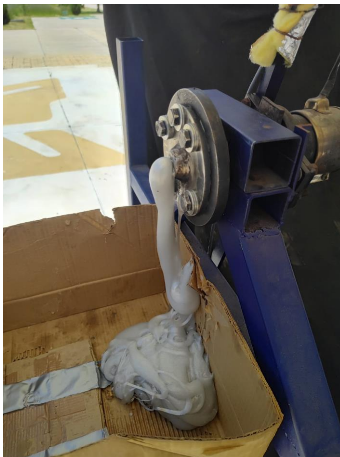
Figura 11. Aspecto del material extruido a la salida de la extrusora del proceso de la corrida 3-eléctrica.
