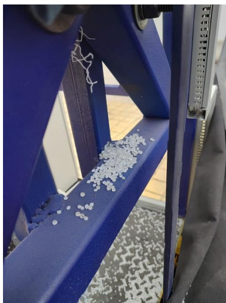
Figura 18. Aspecto de material de extrusión aun en forma de perlas que se fugan por las aberturas entre el cuello de la tolva y la garganta de ingreso del barril. El material puede ser recolectado y su pesaje es caracterizado dentro de la prueba presente.
