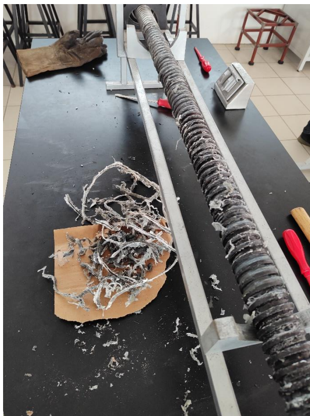
Figura 15. Aspecto de la limpieza del husillo cuando es retirado de la máquina extrusora para mantenimiento. El material es removido de los alabes del husillo y su pesaje es diferenciado de la prueba inmediata siguiente de extrusión.
