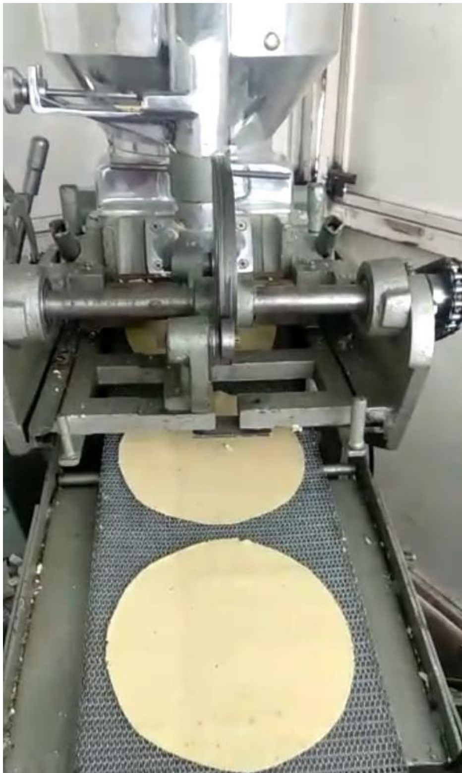
Ilustración 4. Elaboración de Tortilla Tipo Torteada con Cabezal
