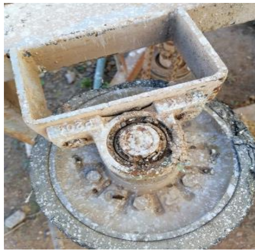
Imagen 13: rueda delantera desgastada
