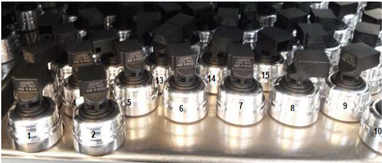
Figura 4.7 Muestreo de piezas comprimidas a diferente fuerzas.
