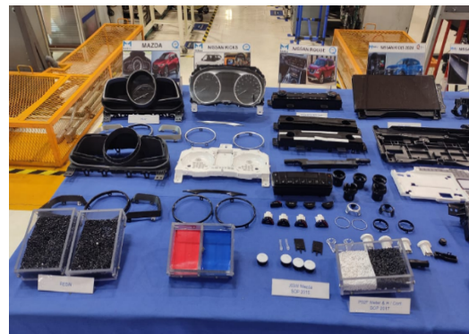
Componentes que se utilizan para los diferentes tableros, desde la resina hasta el producto terminado.
