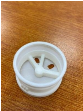
Ilustración 32 rediseño de tapa impresa parte superior
