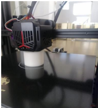
Ilustración 8 impresión de envase en impresora 3D
