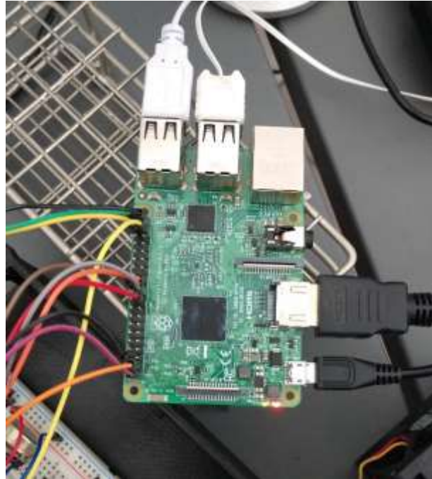
Figura 69. Placa RPi en operación: luz roja indicativo de encendido y luz verde indicativo de registro de lecturas.
