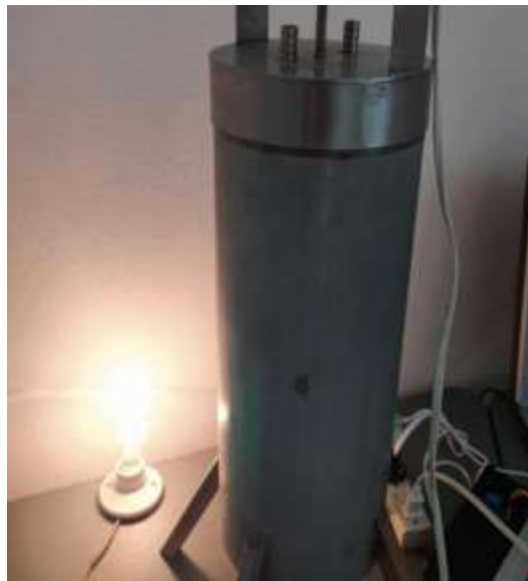
Figura 72. Foco incandescente encendido como indicativo de resistencia eléctrica en ON.
