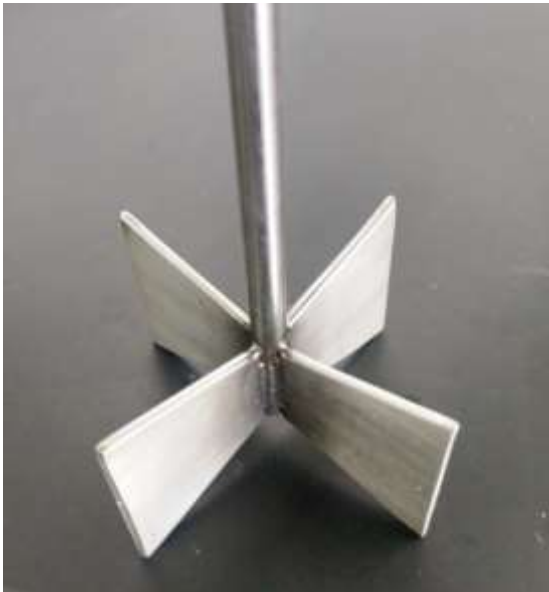
Figura 57. Aspas del agitador propulsor: aspas inferiores (izq.) u aspas superiores (der.).
