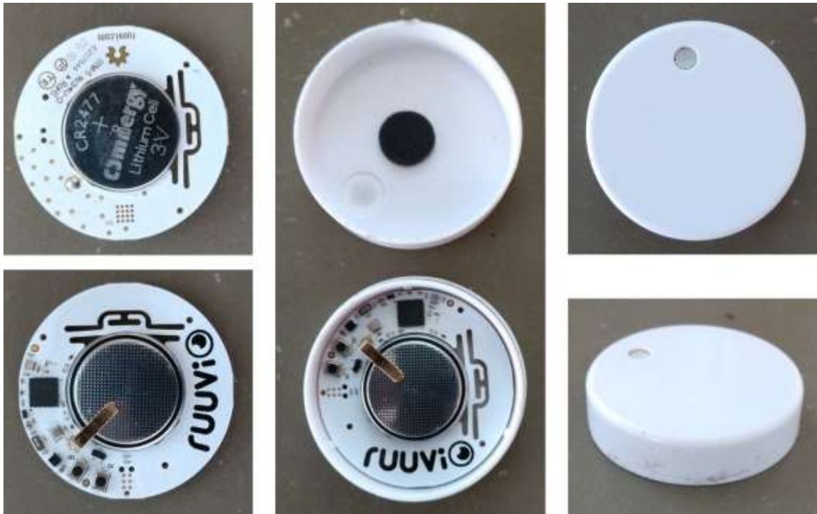
Figura 28. Configuración del sensor inalámbrico RuuviTag 4 en 1: vista posterior (izq. arriba), vista anterior (izq. abajo), secciones separadas (centro), vista superior (der. arriba), vista lateral (der. abajo).
