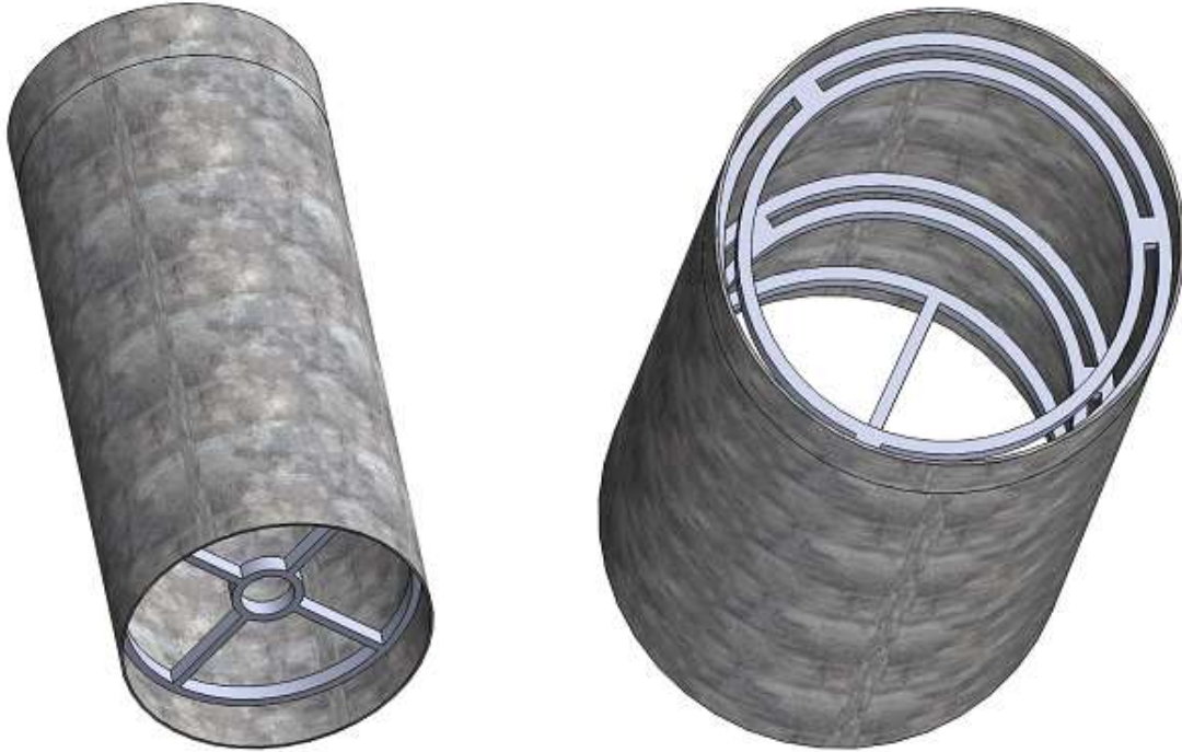
Figura 42. Carcasa: vista interna inferior (izq.) y vista interna superior (der.).
