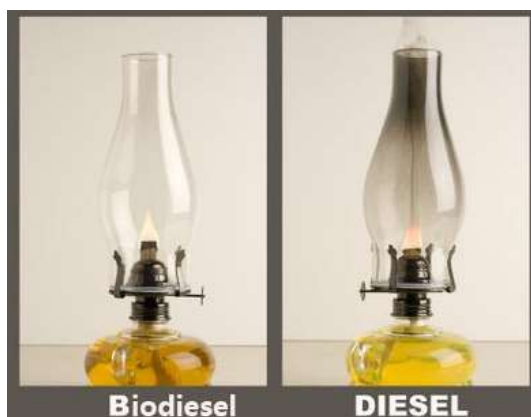
Figura 3. Diferencia de la combustión entre el biodiésel (izq.) y el diésel (der.).
