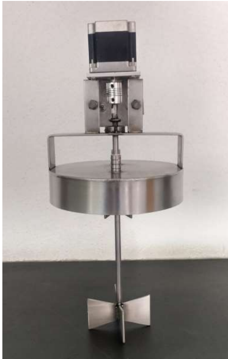
Figura 55. Sistema de agitación: vista completa.
