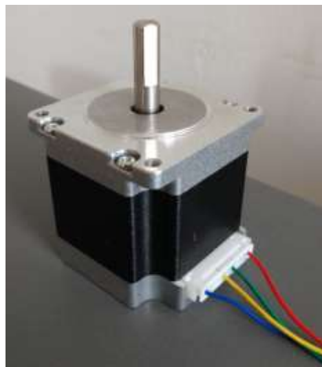
Figura 29. Motor a pasos empleado NEMA 23.
