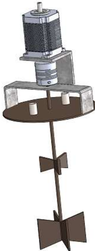
Figura 45. Sistema de agitación: actuador, agitador propulsor.
