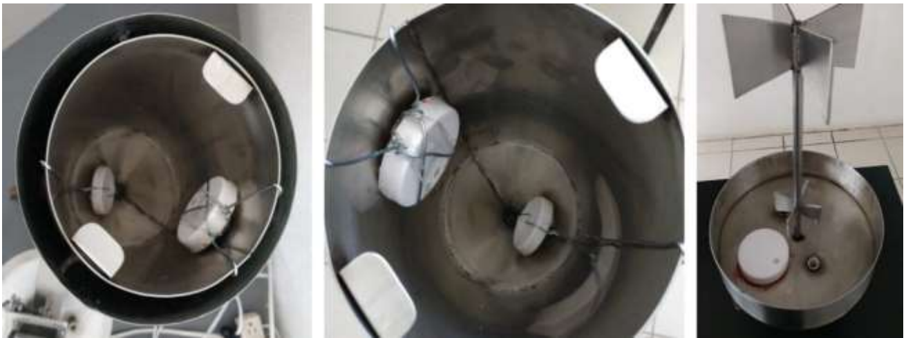
Figura 30. Posición de sensores RuuviTag: vista de los sensores de temperatura y presión en recipiente interno en relación con el recipiente externo (izq.), acercamiento de los sensores en el recipiente interno (centro), sensor de humedad en tapa cilíndrica (der.).
