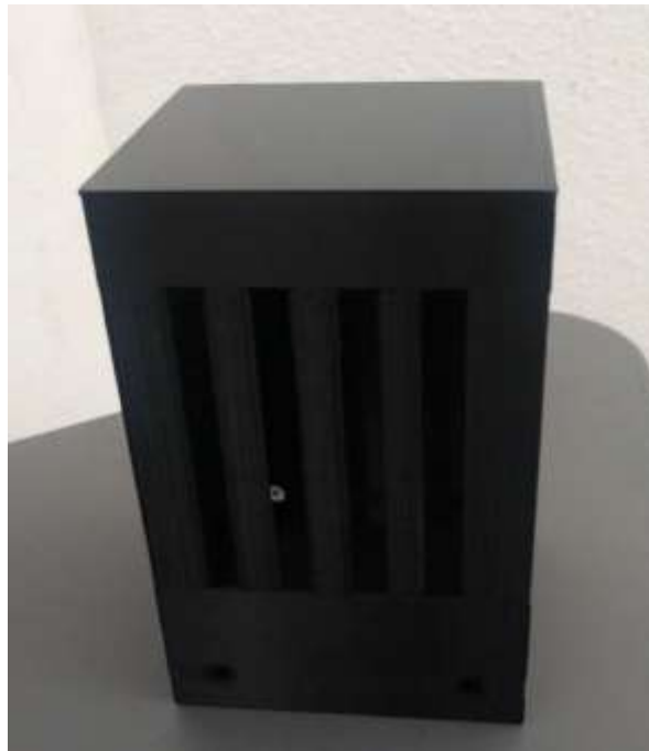
Figura 61. Cubierta impresa de motor.
