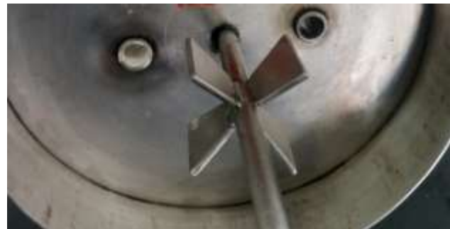
Figura 57. Aspas del agitador propulsor: aspas inferiores (izq.) u aspas superiores (der.).
