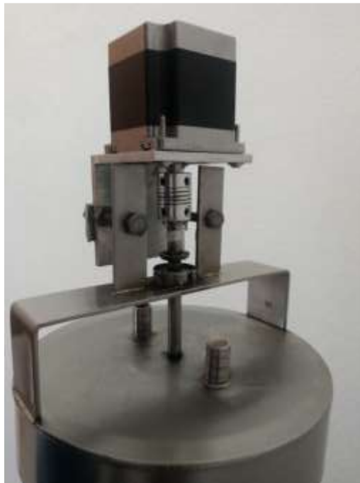
Figura 59. Sistema de agitación: acercamiento anterior donde se observa la abrazadera, actuador, cople, eje del agitador, entradas de alimentación, rodamiento, soporte actuador y tornillería de sujeción.
