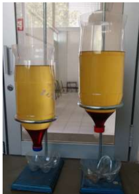
Figura 83. Productos de reacción de transesterificación: corrida 2 (der.) y corrida 4 (izq.) del arreglo 3.
