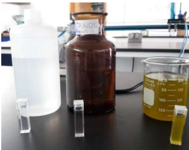
Figura 19. Celdillas con muestras de agua destilada, alcohol y aceite vegetal respectivamente.
