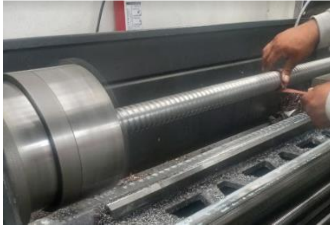
Figura 40. Eliminación de filos en los alabes del husillo mediante lijado.
