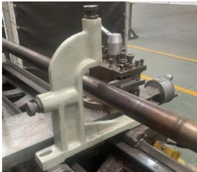
Figura 17. Luneta viajera, permite disminuir la vibración y evitar la elongación.
