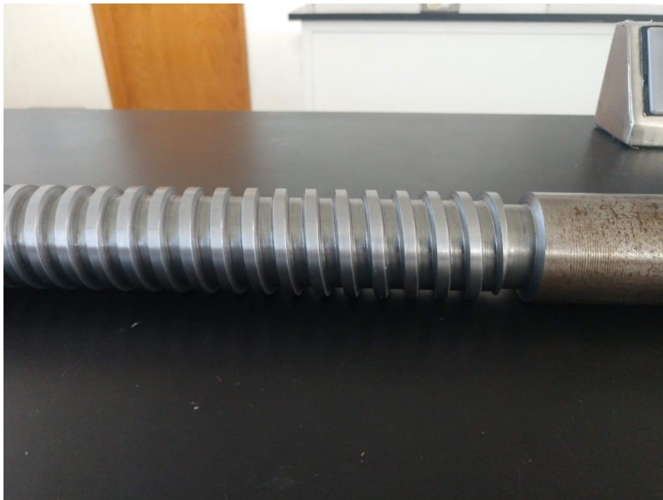
Figura 43. Acercamiento de alabes maquinados (extremo del husillo adjunto al cuello).
