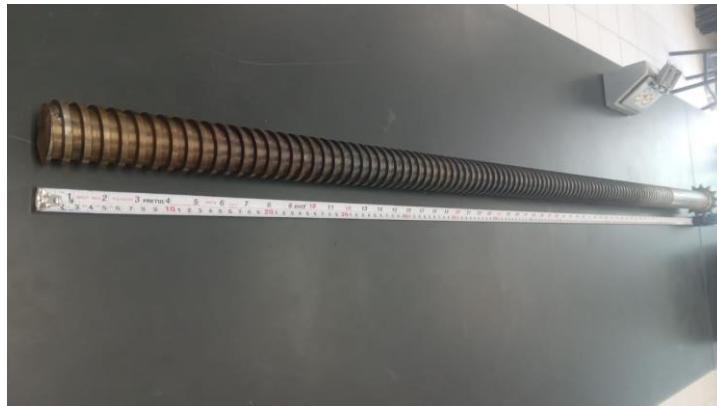
Figura 46. Medición de longitud del husillo con flexómetro.
