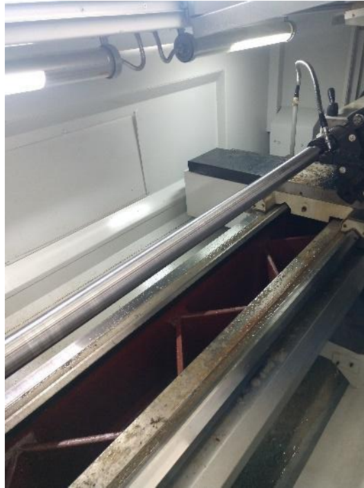
Figura 34. Torneado inicial de husillo para ajuste al barril (maquinado previo al de formación de alabes). Actividad realizada dentro de ITPA. Disminución de diámetro de 50 a 48.5 mm.
