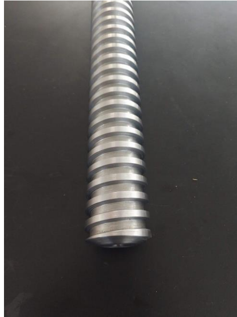
Figura 42. Acercamiento de alabes maquinados (punta del husillo).
