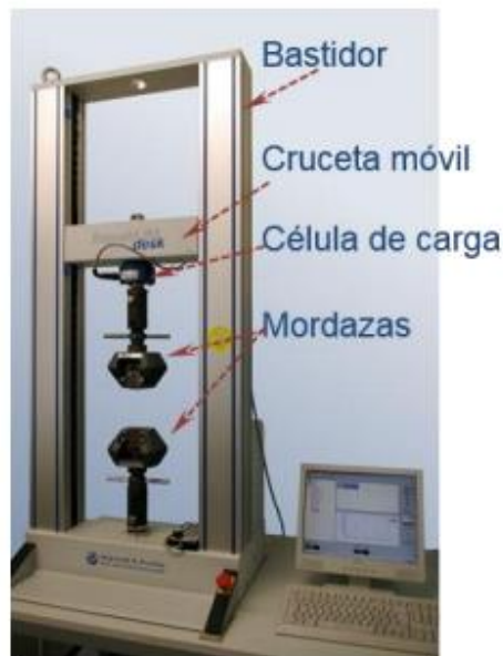
Figura 14. Máquina universal de ensayos. Fuente: [36].
