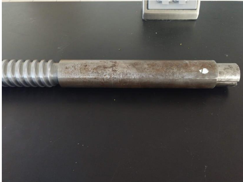
Figura 44. Cuello del husillo con ranura para comunicación con sistema de empuje.
