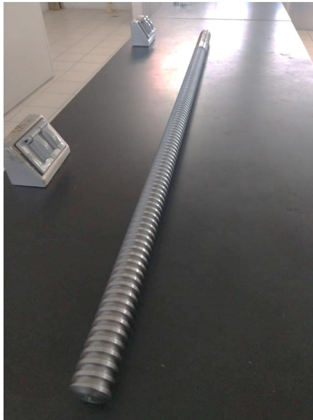
Figura 41. Vista completa del husillo con alabes maquinados.
