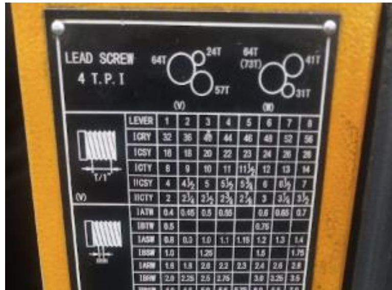
Figura 20. Configuración de los parámetros del torno para la generación de rosca tipo ACME.
