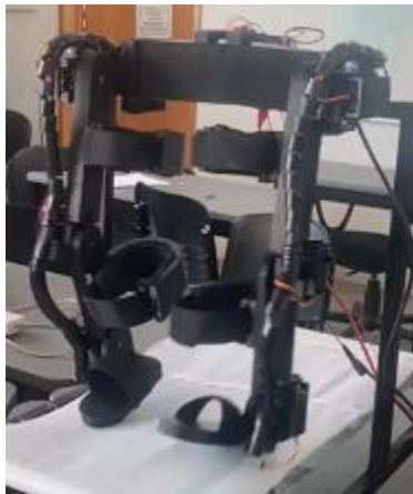
Ilustración 15. exoesqueleto impreso en PLA
