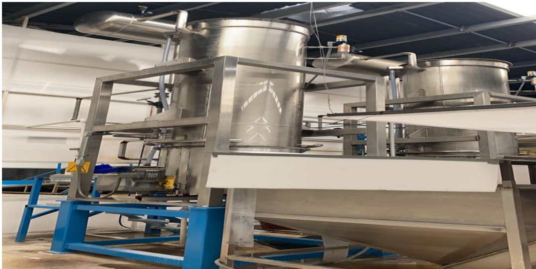
Figura 7. En esta imagen podemos observar la máquina de roll como se muestra está conformado por un tambor grande donde produce el hielo en cubo y también va conectado a una tina donde llega a caer todo el hielo.
