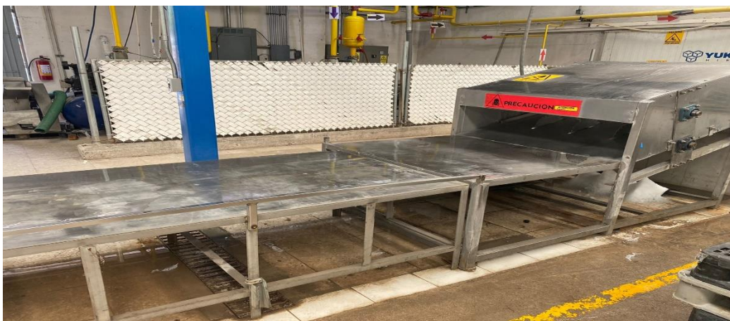
Figura 8. En esta imagen nos muestra la maquina cortadora de barra esta máquina está conformado por discos de cortadora de hielo y lleva conectado una mesa de aluminio.
