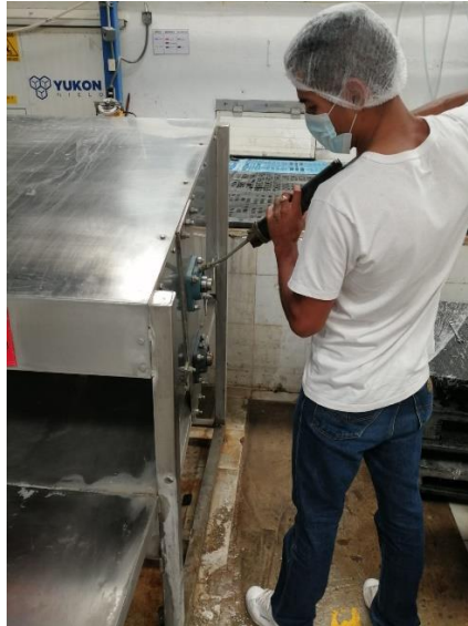
Figura 34 , mantenimiento 5 en esta imagen podemos observar cómo será engrasado el porta balero con la finalidad de dejarlo en buenas condiciones.
