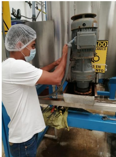
Figura 31 , mantenimiento 2 como podemos observar en esta imagen se tuvo que ajustar la cadena de la máquina de roll.
