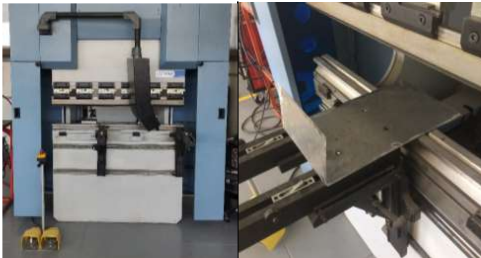
Figura 39. Maquina utilizada para doblar y pieza doblada.
