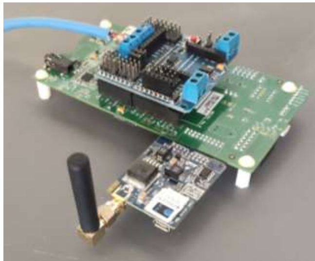
Figura 66. Conexión de la Shield a la placa de desarrollo L496G.
