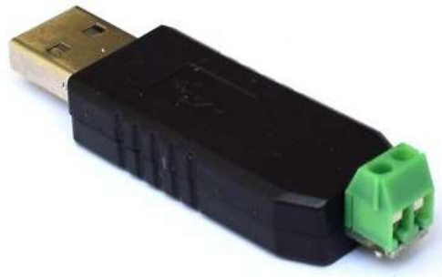
Figura 27. Conversor USB a RS-485
