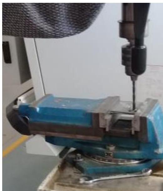
Figura 62. Manufactura del robot cartesiano: barrenado de piezas con taladro de banco y una broca de 6.8 mm.
