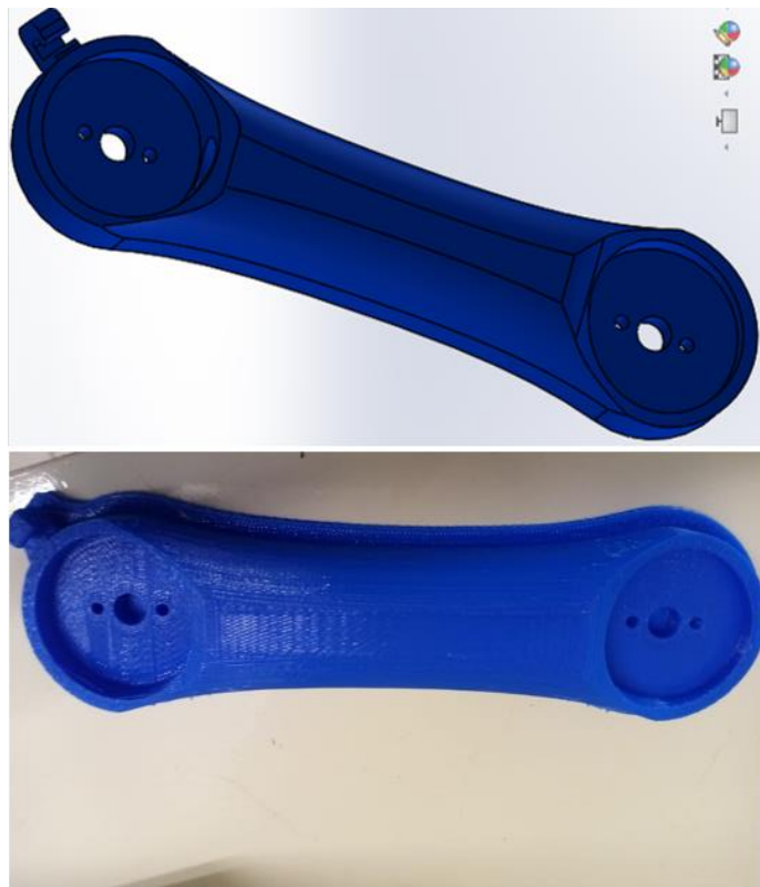
Figura 40. Comparación entre el del diseño CAD y la impresión terminada del segundo eslabón del brazo.
