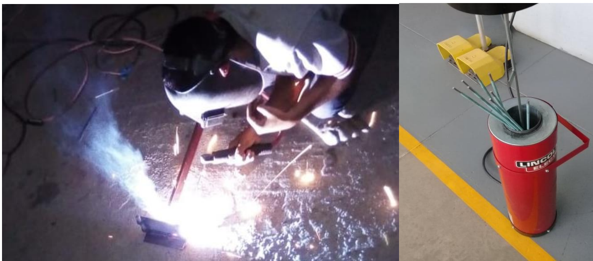
Figura 61. Manufactura del robot cartesiano: soldadura.
