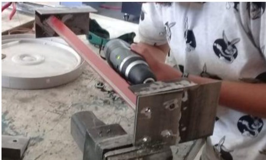
Figura 63. Manufactura del robot cartesiano: perforación de orificios para sujetar los baleros con tornillos y tuercas.
