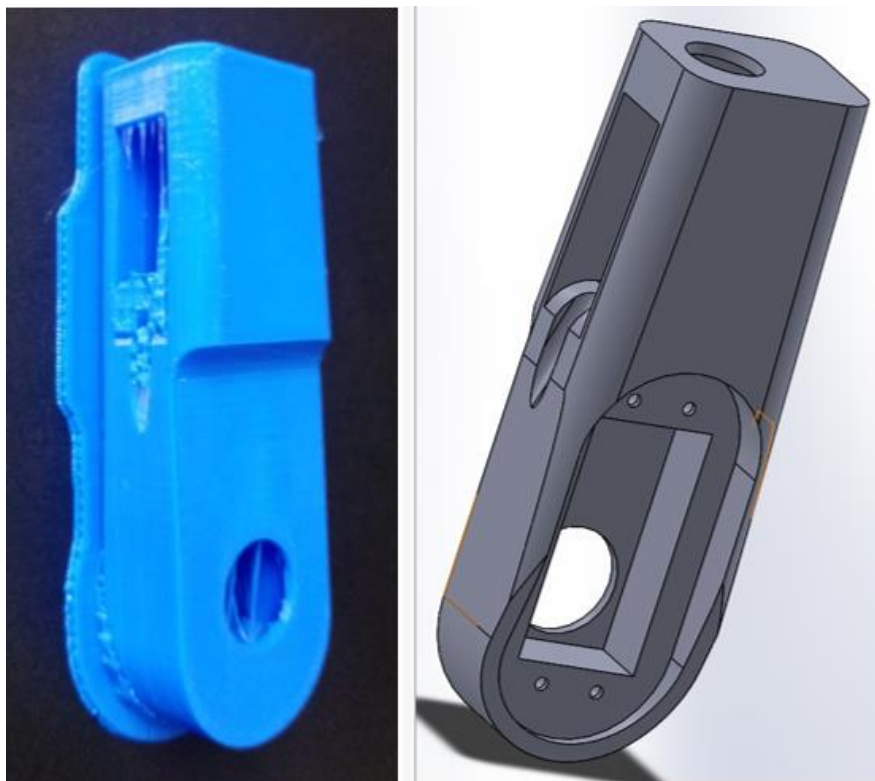
Figura 44. Comparación entre el diseño CAD y la impresión terminada del Tercer eslabón del brazo robot.
