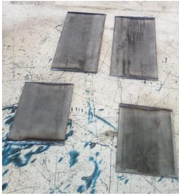
Figura 60. Soleras de sujecion.
