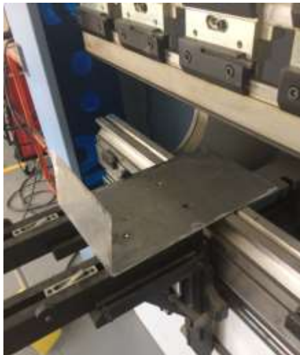
Figura 40. Partes de gabinete dobladas en la prensa.
