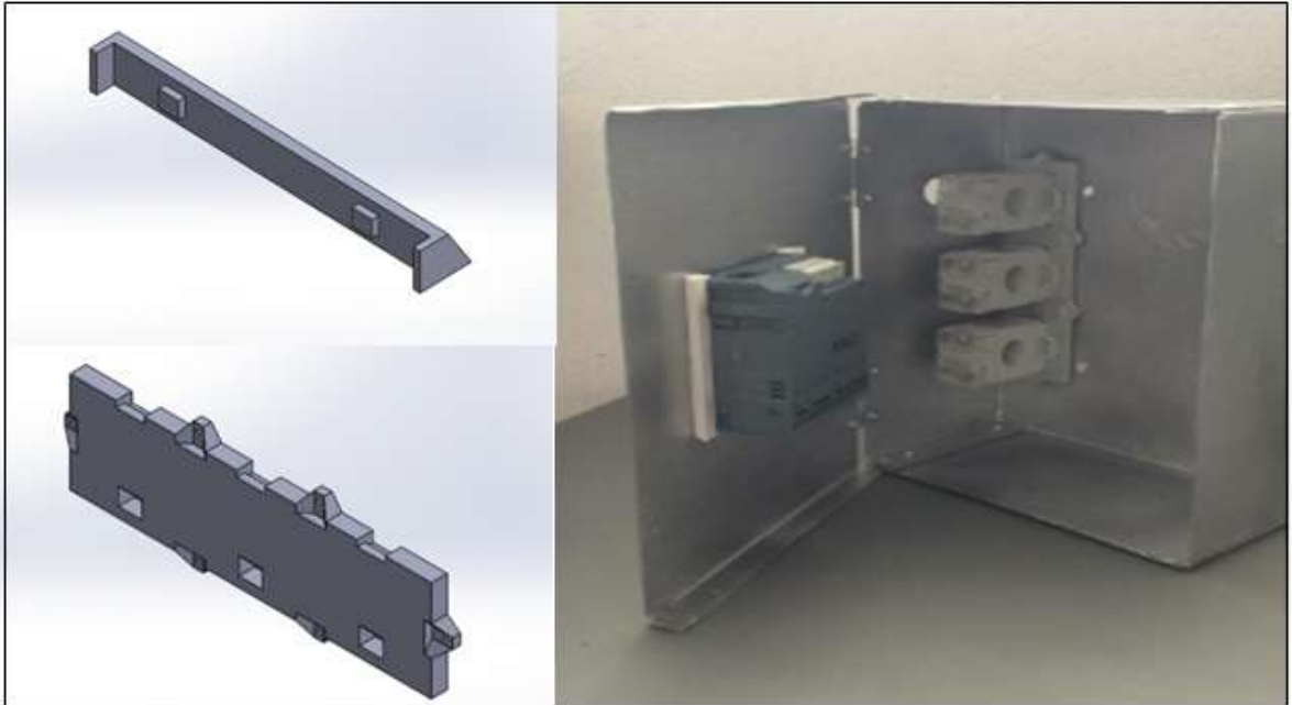
Figura 49. Porta transformadores y mecanismo de sujeción.
