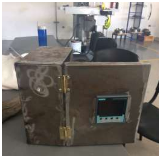
Figura 44. Ensamble del gabinete final.
