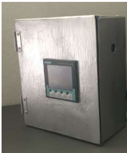
Figura 45. Gabinete con pintura anti eléctrica aplicada.
