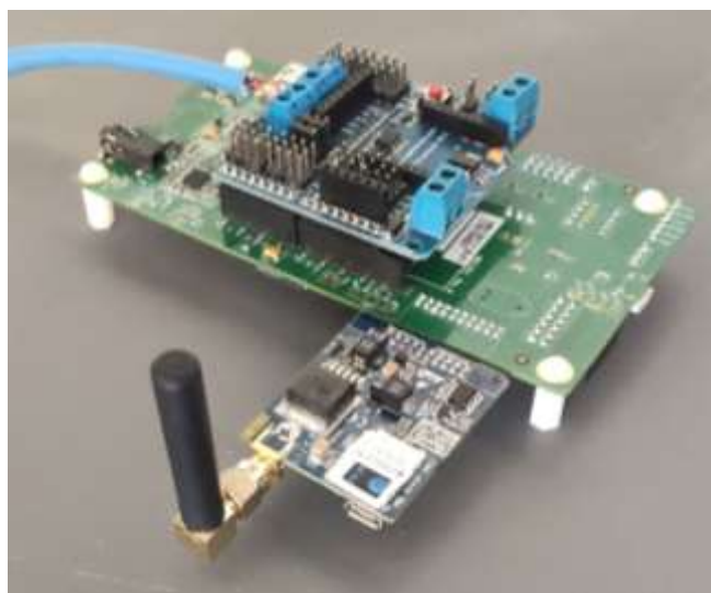
Figura 67. Conexión de la Shield a la placa de desarrollo L496G.
