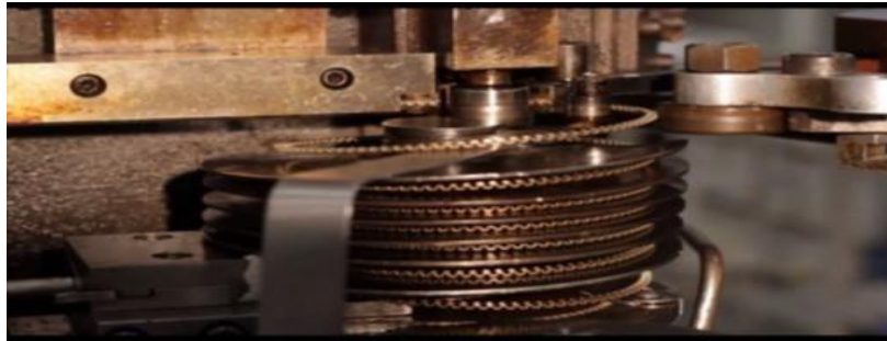
Figura 3 - Troqueladoras de alambre para fabricación de expansores.
