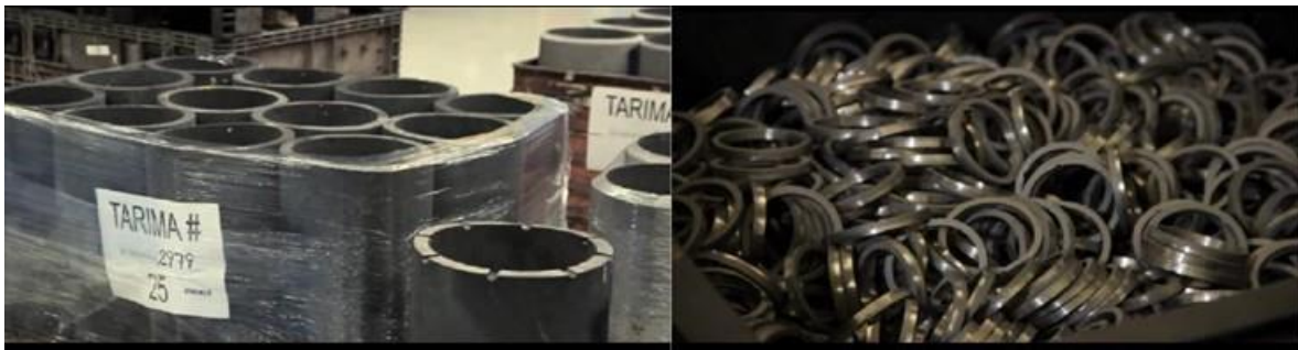
Figura 1 - Tubos de hierro gris y castings para la fabricación de anillos.
