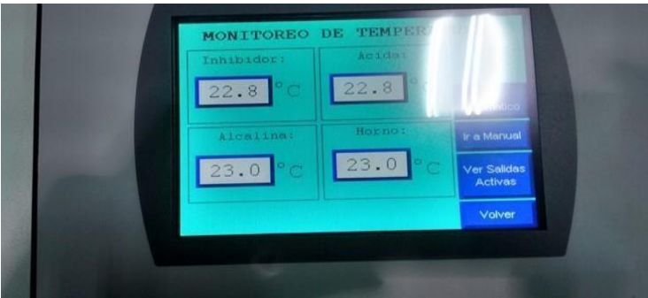
Figura 60 - Resultado en la pantalla HMI de la prueba del sensor.
