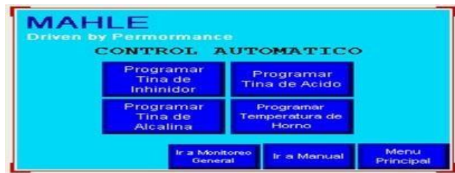
Figura 45 - Pantalla 3: Control Automático.
