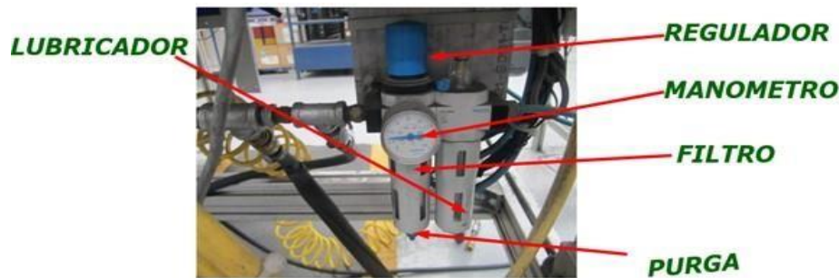
Figura 16 – Unidad FRL (Filtro Regulador de Lubricación)
