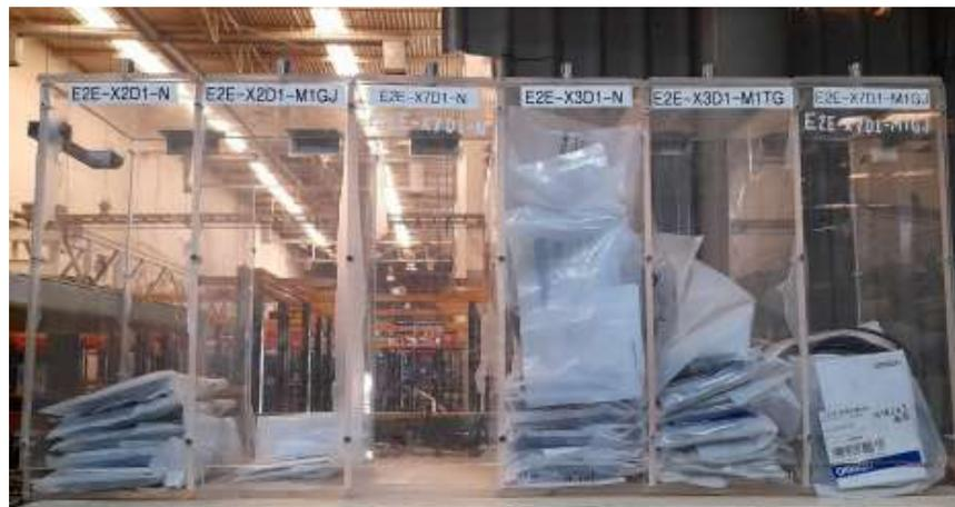
**Figura 25.** Gaveta de refacciones adicionales de sensores.
