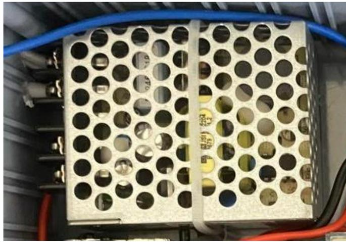
*Ilustración 28.- Regulador de voltaje*
