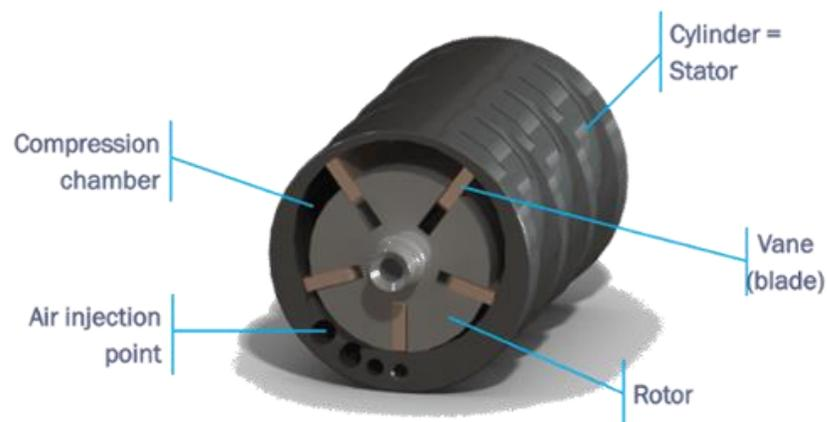
*Ilustración 8.- Motor neumático y sus partes*
