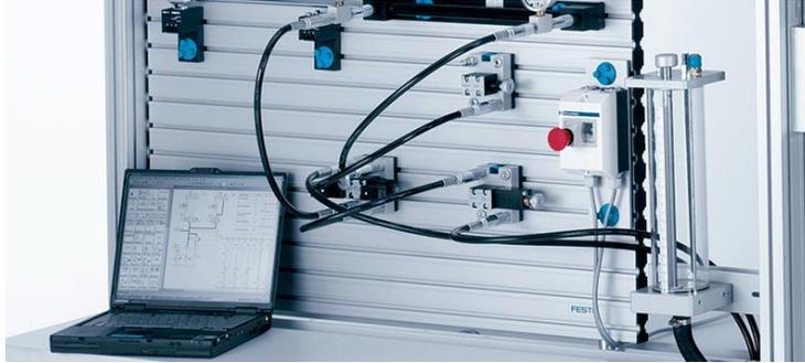
*Ilustración 9.- Sistema electroneumático*
