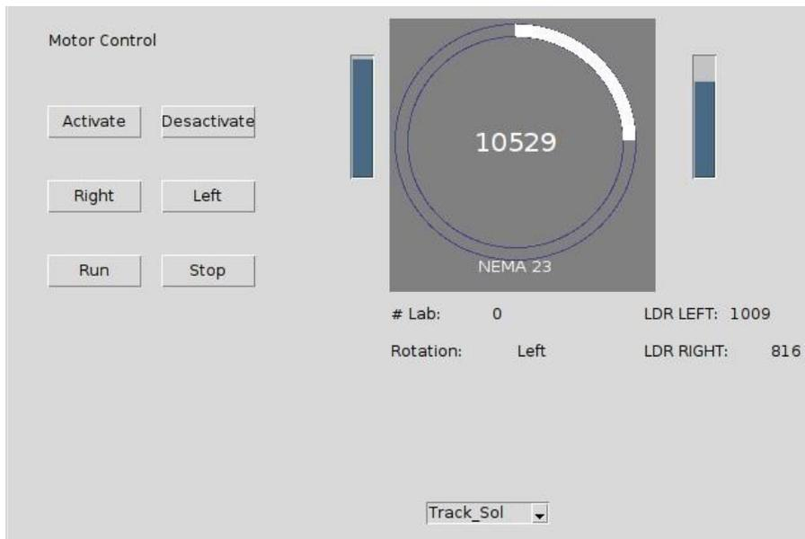
**Figura 25.** Interfaz de condición con rotación a la izquierda (sentido anti horario): Función, Track\_Sol; LDR LEFT, 1009; LDR RIGHT, 816; la rotación del motor es hacia la izquierda hasta detenerse y mantener la radiación solar concentrada en el barril.
