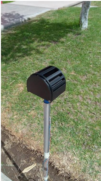
**Figura 18.** Sensor solar: vista de las ventanas de la carcaza.
