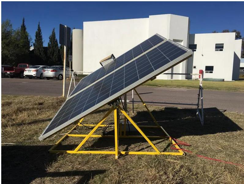
**Figura 10.** Panel seguidor solar [17].
