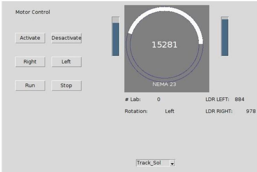
**Figura 24.** Interfaz de condición con motor detenido (sin rotación): Función, Track\_Sol; LDR LEFT, 884; LDR RIGHT, 978; se mantiene radiación solar concentrada en el barril.
