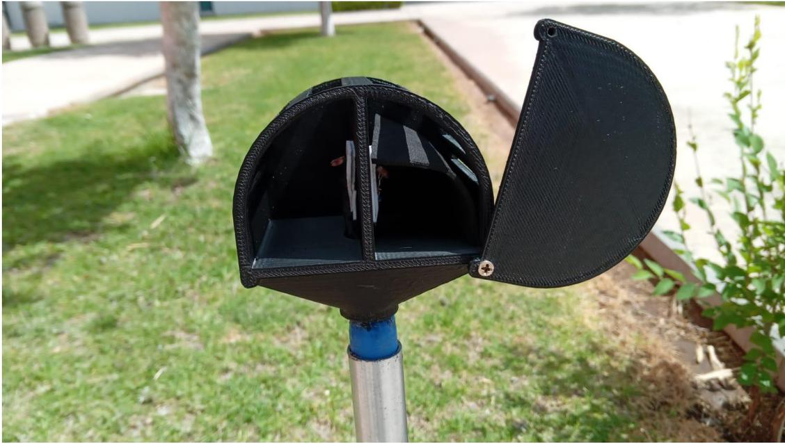
**Figura 19.** Sensor solar: vista interna de la carcaza del sensor solar.
