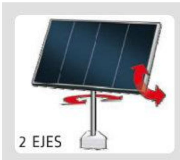
**Figura 8.** Seguidor solar en dos ejes [13].
