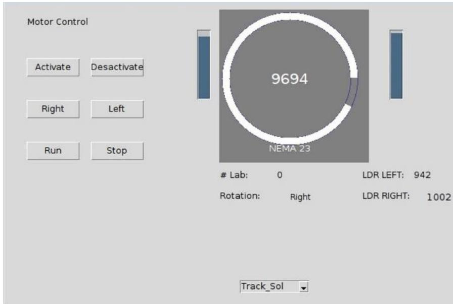
**Figura 26.** Interfaz de condición con rotación a la derecha (sentido horario): Función, Track\_Sol; LDR LEFT, 942; LDR RIGHT, 1002; la rotación del motor es hacia la derecha hasta detenerse y mantener la radiación solar concentrada en el barril.
