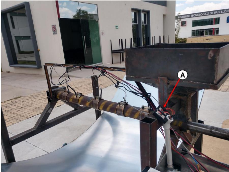
**Figura 22.** Vista del sensor solar (A) instalado en máquina extrusora híbrida.
