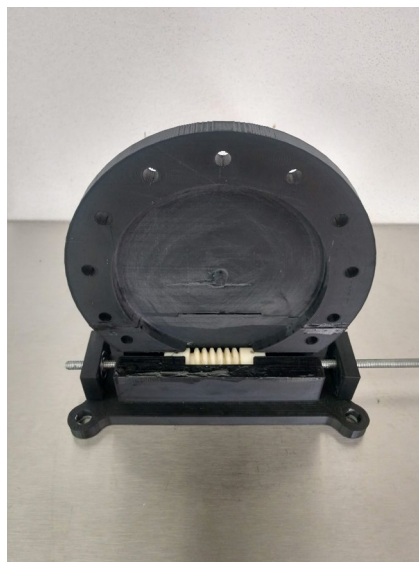
Figura 32. Vista del tornillo situado en la base de la carcasa.
