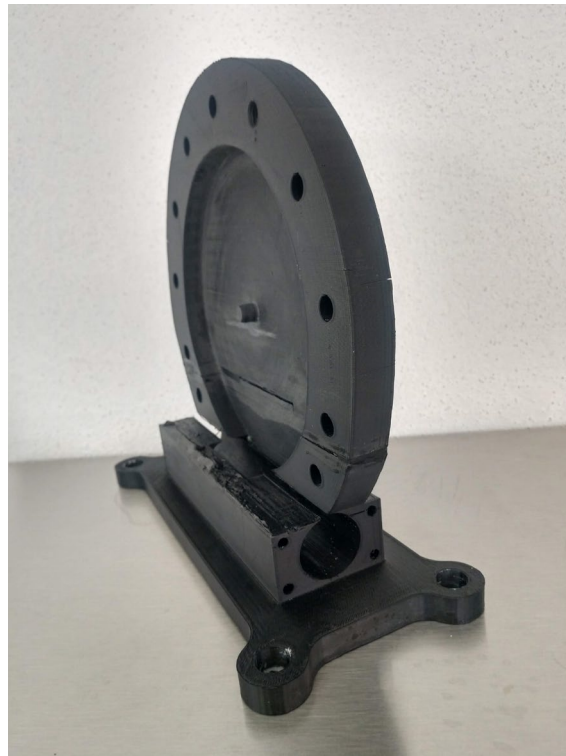
Figura 27. Vista en perspectiva de la base y tapa trasera de la carcasa de la unidad de giro.
