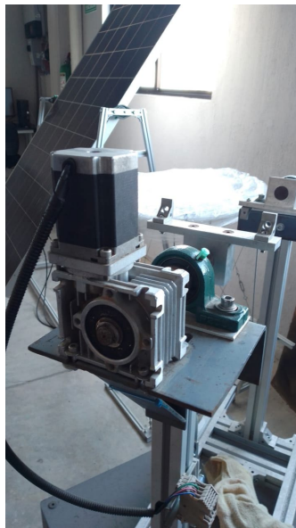
Figura 13. Slewing drive comercial (propiedad de CIO, A.C. Unidad Aguascalientes).
