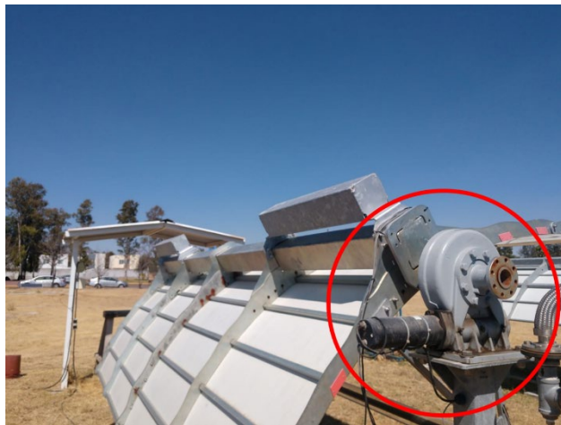
Figura 12. Slewing drive comercial (propiedad de CIO, A.C. Unidad Aguascalientes).
