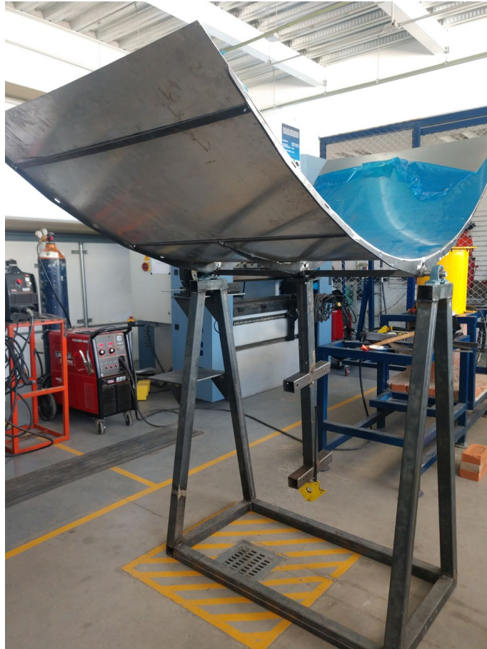
Figura 16. Colector solar de canal parabólico de estudio.
