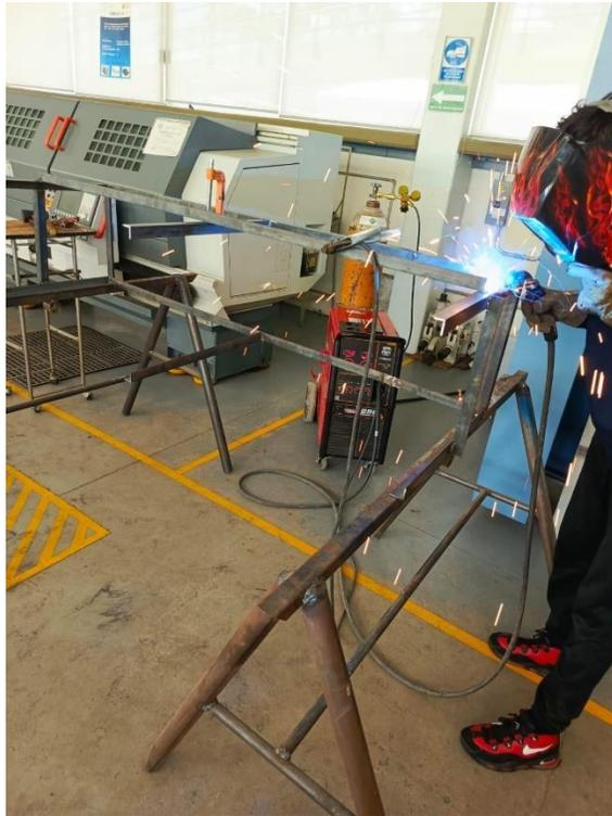
**Figura 17.** Soldadura de la base del tanque de enfriamiento.
