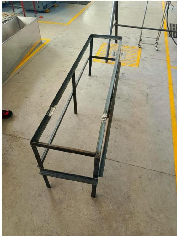
**Figura 19.** *Ensamble de base del tanque de enfriamiento.*
