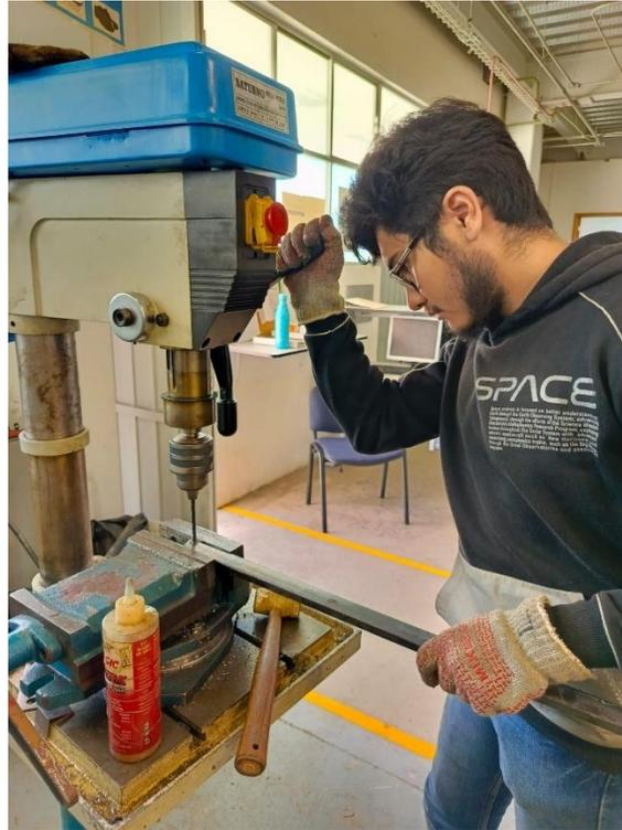
*Figura 21. Taladrado de soportes de la base de la torre.*
