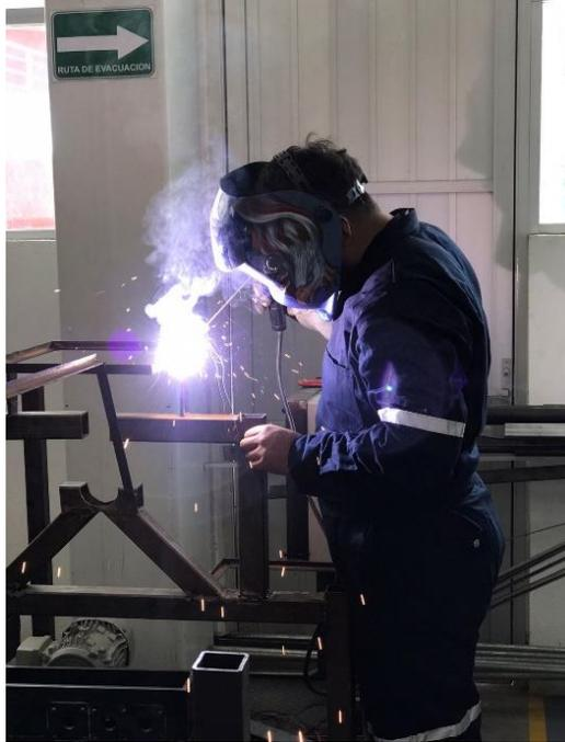
**Figura 7. Soldadura MMA.**
