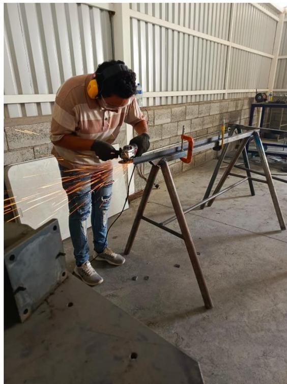
*Figura 22. Esmerilado de soportes de la base de la torre.*
