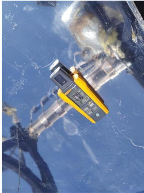
**Figura 36.** Registro de lecturas de irradiación solar durante del proceso de la corrida 2-hibrida.
