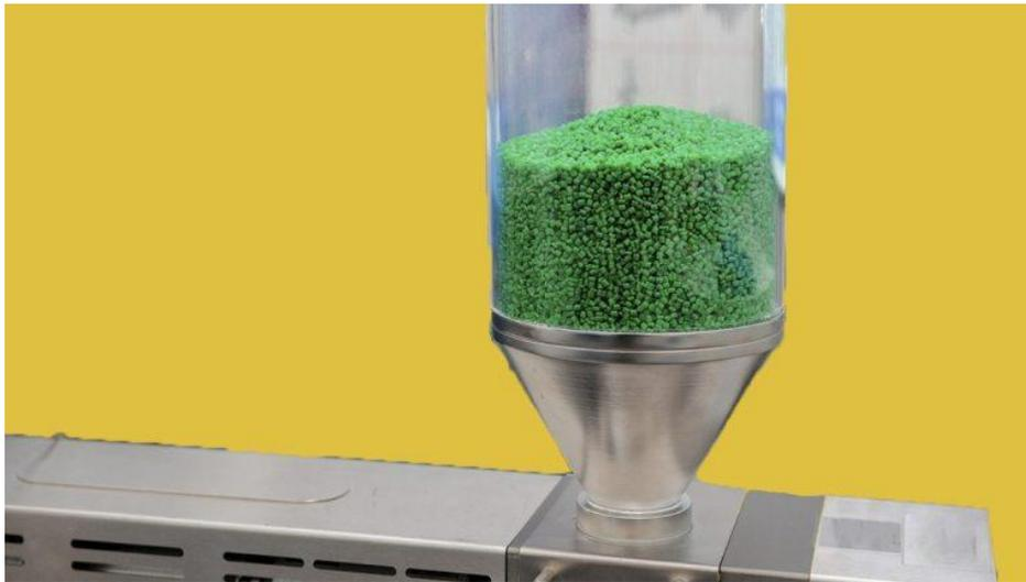
*Figura 3. Ejemplo de plástico extruido en gránulos [3].*
