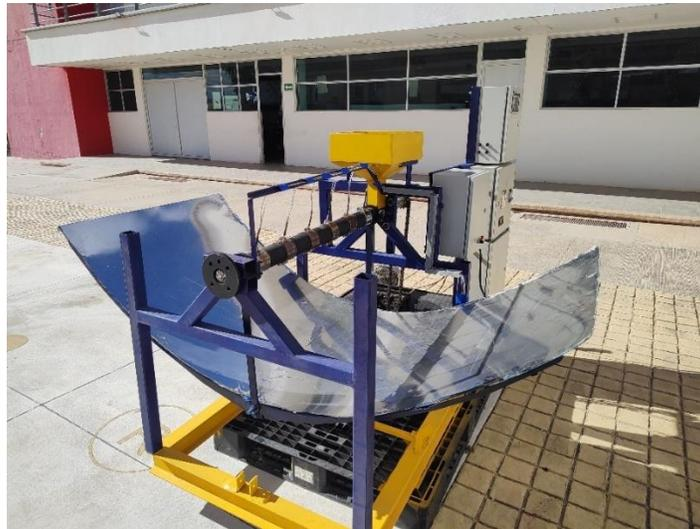
**Figura 11.** Máquina extrusora híbrida horizontal de estudio.
