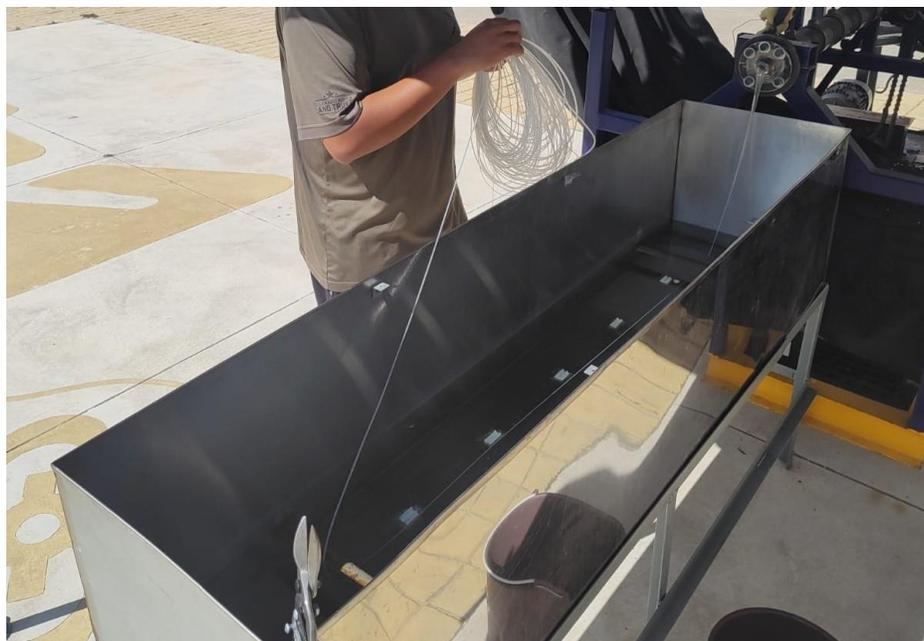
**Figura 33.** Recolección manual de filamento de plástico CON el uso del módulo de coagulado.
