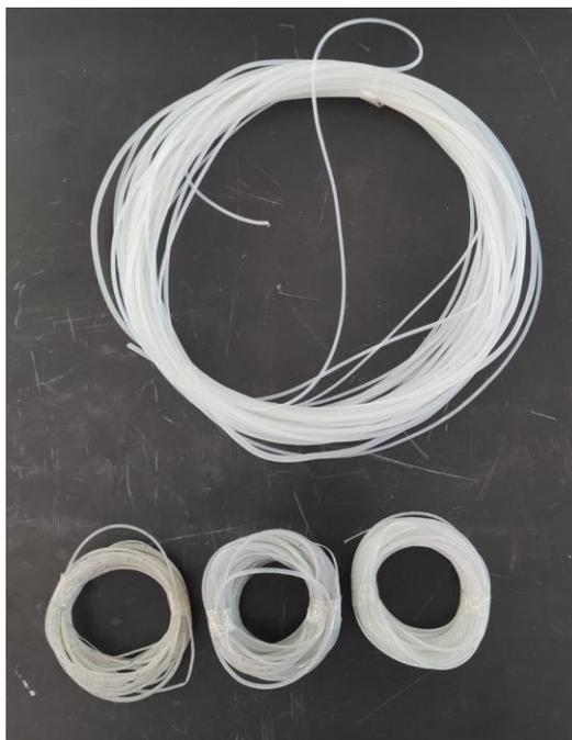
**Figura 35.** Aspecto del filamento de plástico extruido y recolectado CON el uso del módulo de coagulado.
