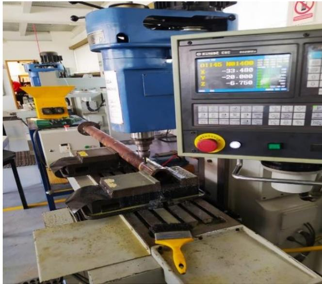
**Figura 6.** Mecanizado por fresado. Vista de máquina fresadora del taller sede.
