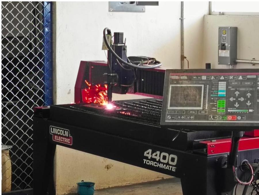
**Figura 24.** Corte por plasma de bases de nivelación de torre.
