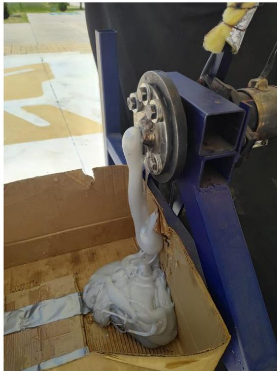
**Figura 29.** Aspecto del material extruido a la salida de la extrusora del proceso de la corrida 3-eléctrica SIN el uso de módulo de coagulado.
