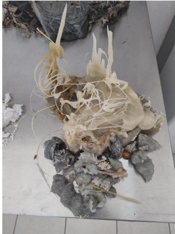
**Figura 30.** Aspecto “pata de elefante” del material extruido ya enfriado y resultante del proceso de la corrida 2-hibrida SIN el uso de módulo de coagulado.
