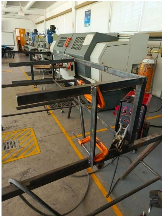
**Figura 18.** Armado de base del tanque de enfriamiento.
