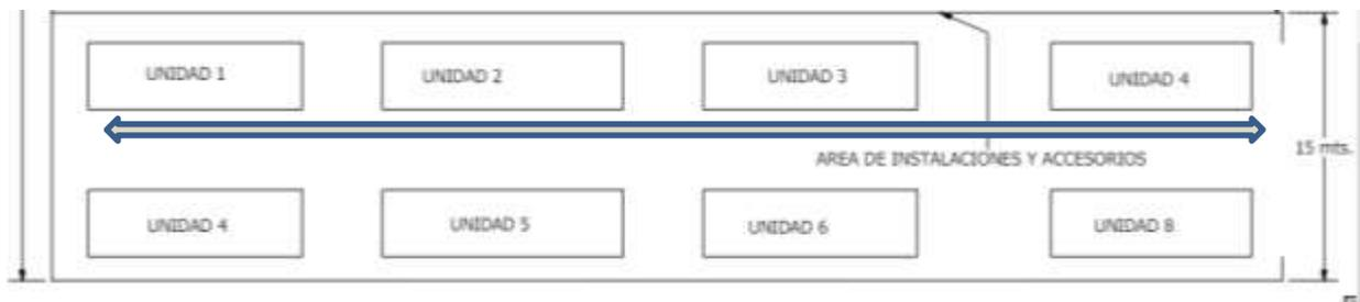
Todo montacargas puede transitar en el sentido que la flecha lo marca siempre y cuando el pasillo este despejado. Para mover las unidades es necesario usar el montacargas Baoli FD50K1 o el KAM M50 debido al peso de carga y las dimensiones que componen las unidades.
