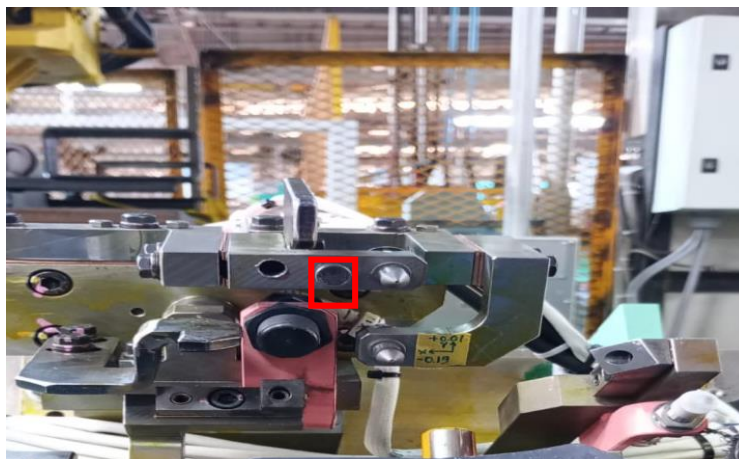
Figura. 5.2 Se insertó el imán en el JIG.
