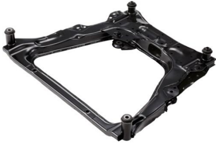
Ilustración 2. 9 Suspensión delantera (Front Suspension Member) Fuente: Lista de productos – Coche | YOROZU (yorozu-corp.co.jp), 2023.
