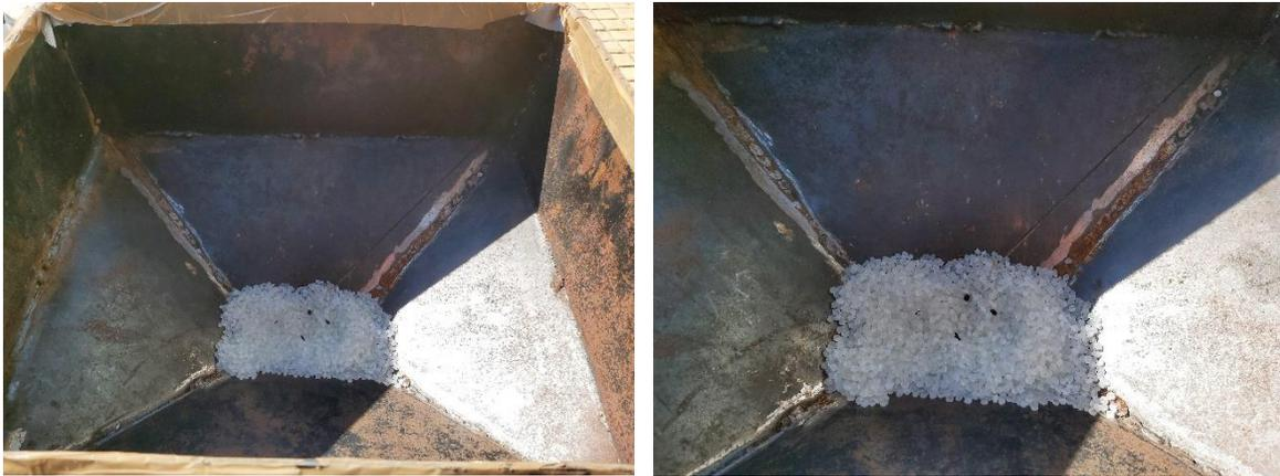
**Figura 15.** Aspecto de las perlas de polietileno en la tolva de la extrusora.
