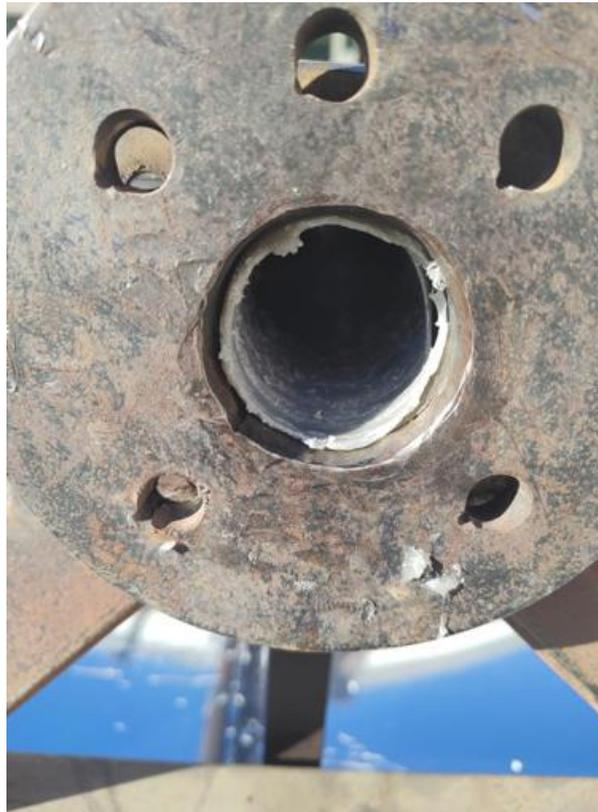
**Figura 20.** Material extruido alojado en las paredes del barril de la extrusora: corrida 4.
