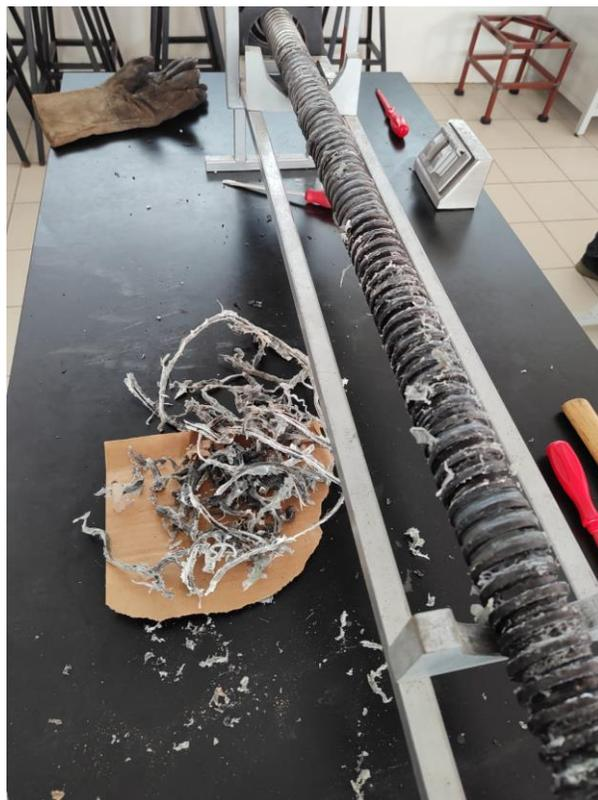
**Figura 18.** Material retirado del husillo resultante de una extrusión: corrida 2.
