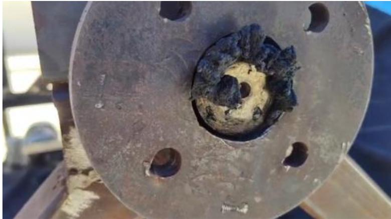
**Figura 21.** Material extruido a la salida de la boca extrusora: corrida 1.
