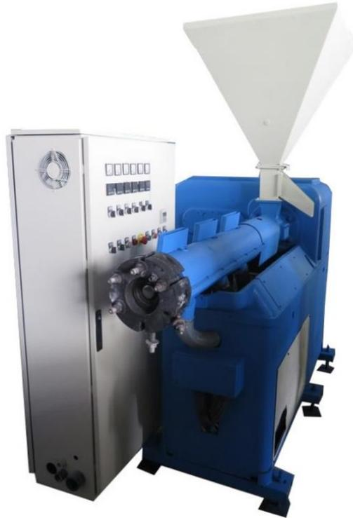
*Figura 4. Máquina extrusora [2].*
