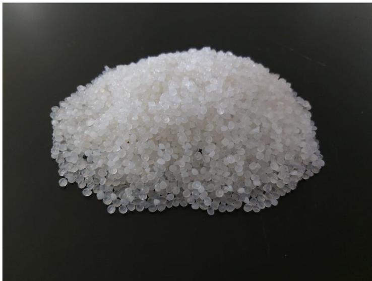
**Figura 14.** Aspecto de las perlas de polietileno a base de resina de baja densidad empleadas.
