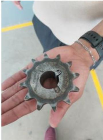
**Figura 23.** Desgaste de la cuña de ajuste del sprocket de la transmisión de la máquina.
