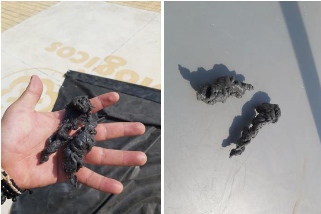
**Figura 16.** Aspecto del material extruido a la salida de la boca extrusora de la máquina: corrida 4.
