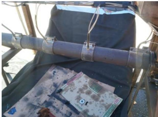
**Figura 24.** Aspecto de las resistencias eléctricas con fallas operativas empleadas en este trabajo.
