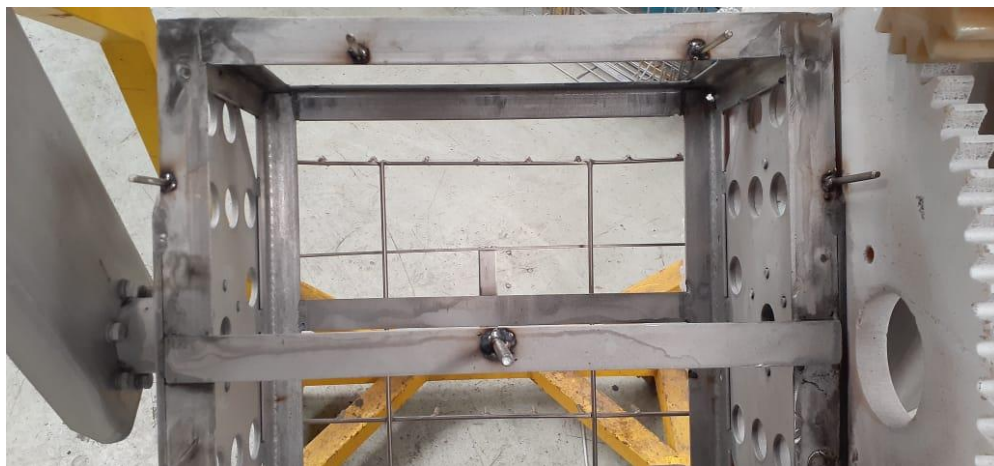
Figura 21.- Tornillo soldado en parte externa del barril con topes de seguridad para caset externo. Fuente: Elaboración propia.
