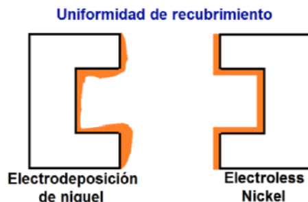
Figura 7.- Diferencia en la uniformidad entre el níquel electrodepositado y el ENP.
