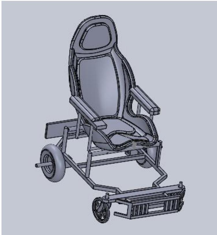
*Ilustración 9. 3 Asiento presentado en un chasis con otro diseño de dirección. Fuente; elaboración propia.2023.*
