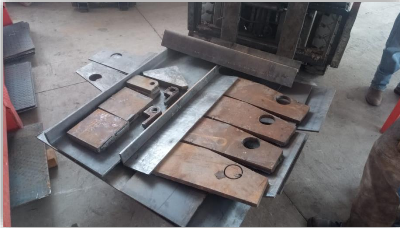
Figura 344: Placas de aumento para descanso de cilindros, orejas, refuerzos para estructura de PTR y orejas para PTR. Fuente: (TTSA, 2023)
