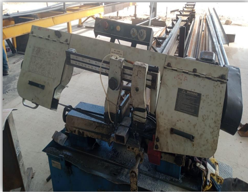
Figura 103: Corte de patas de tarimas. Fuente: (TTSA, 2023)
