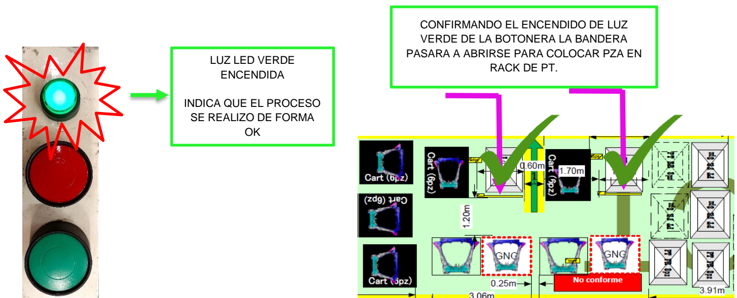
Ilustración 4.10 Confirmación OK de funcionamiento de sistema ANDON. Fuente: Elaboración propia.
