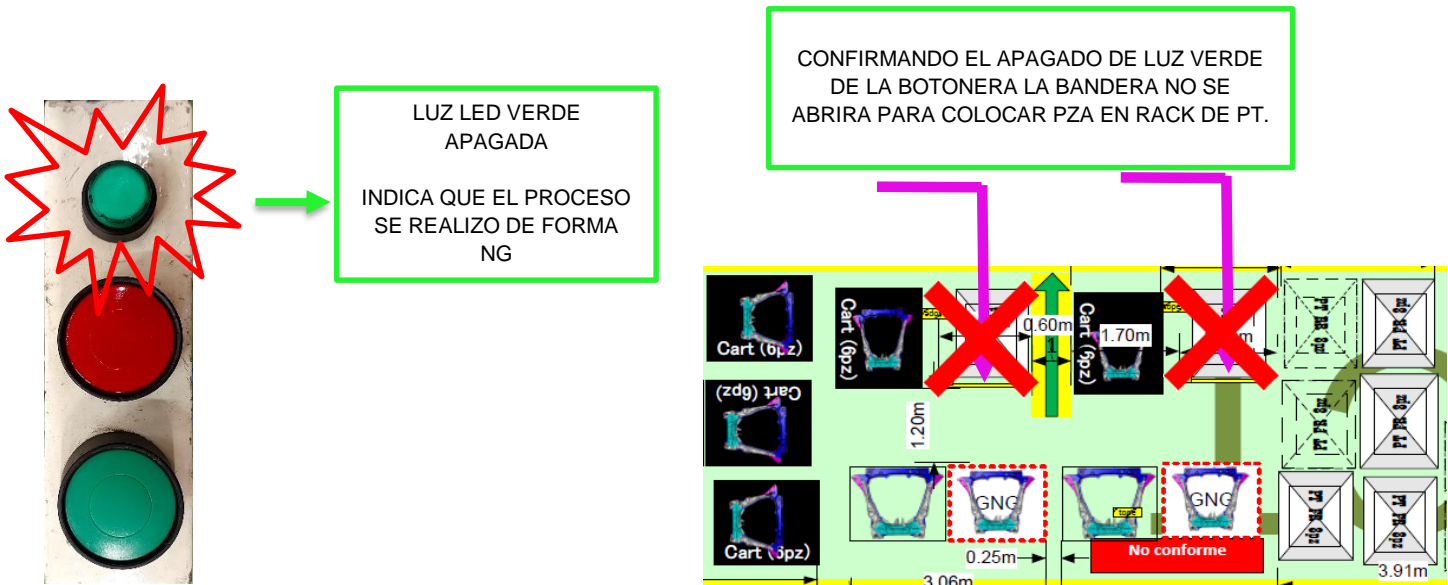
Ilustración 4.11 Confirmación OK de funcionamiento de sistema ANDON. Fuente: Elaboración propia.
