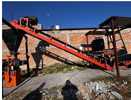
Figura 15. Traslado de mezcla de la revolvedora a la tolva
