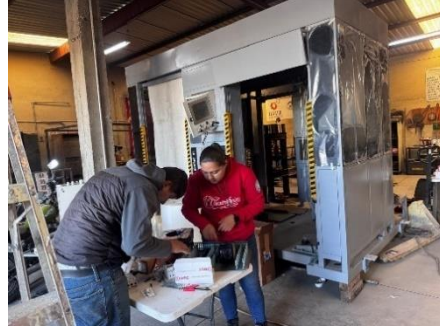
Figura 26. Celda de soldadura robotizada.
