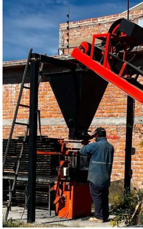
Figura 16. Fabricación de blocs en la compactadora
