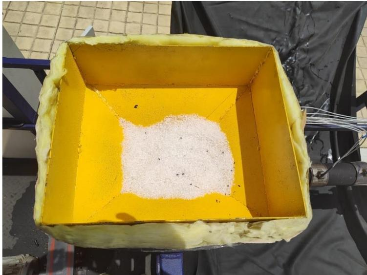
**Figura 18.** Material en tolva de alimentación del proceso de la corrida 3-eléctrica.
