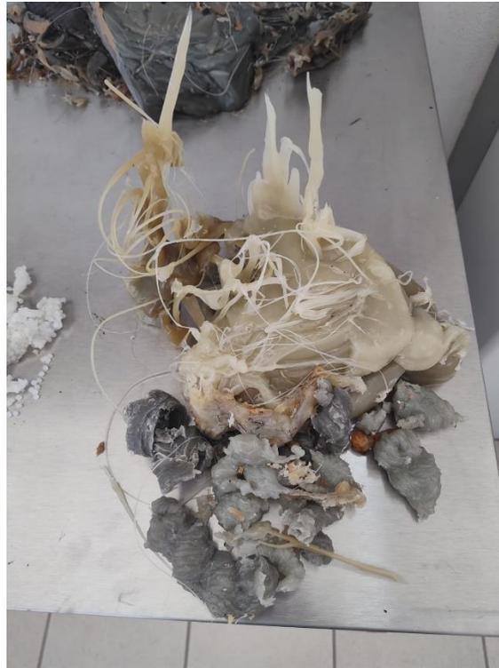
**Figura 20.** Aspecto “pata de elefante” del material extruido ya enfriado y resultante del proceso de la corrida 2-hibrida SIN el uso de módulo de coagulado.
