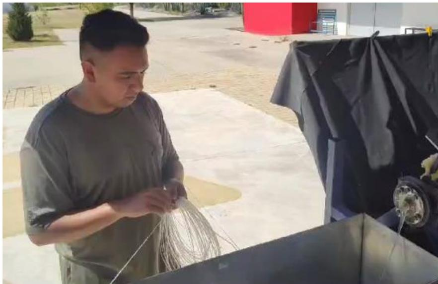
**Figura 23.** Recolección manual de filamento de plástico CON el uso del módulo de coagulado.
