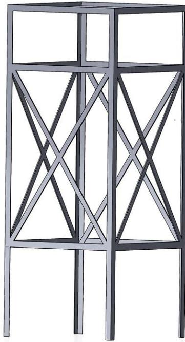
**Figura 15.** Diseño isométrico del módulo de coagulado: torre de enfriamiento.
