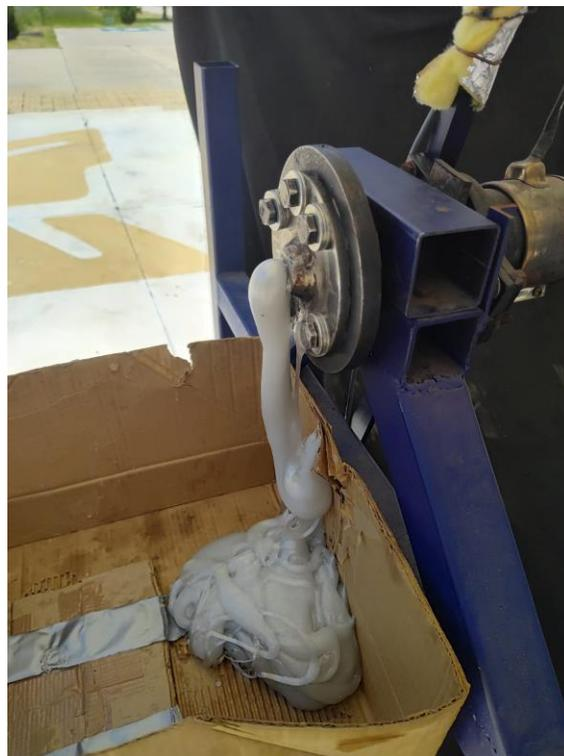
**Figura 19.** Aspecto del material extruido a la salida de la extrusora del proceso de la corrida 3-eléctrica SIN el uso de módulo de coagulado.
