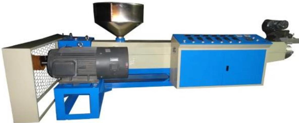
**Figura 2.** Ejemplo de máquina extrusora de plástico [2].
