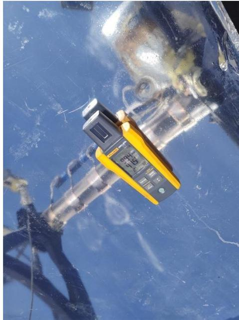
**Figura 26.** Registro de lecturas de irradiación solar durante del proceso de la corrida 2-hibrida.
