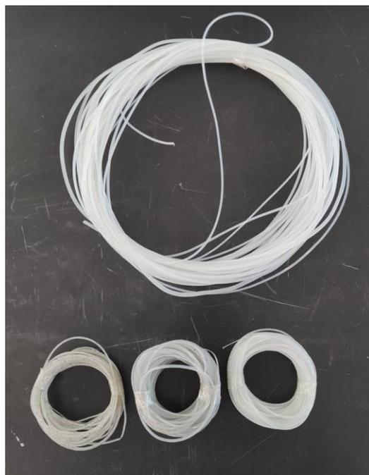
**Figura 25.** Aspecto del filamento de plástico extruido y recolectado CON el uso del módulo de coagulado.
