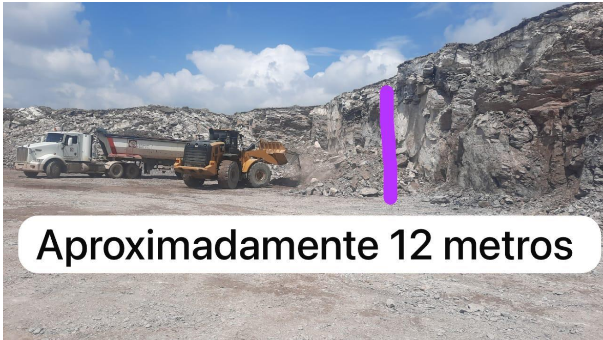
Ilustración 1 Banco primario de extracción de piedra caliza yacimiento cantera ranchito. Tomado del recorrido realizado de la empresa CYCNA empresa de Tepezalá, Aguascalientes y sus anexos.
