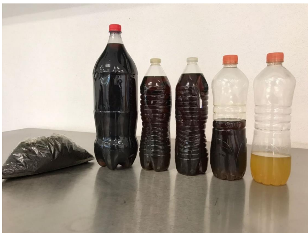
Figura 18. Combustible líquido bruto (sin refinar) obtenido de la corrida 3.
