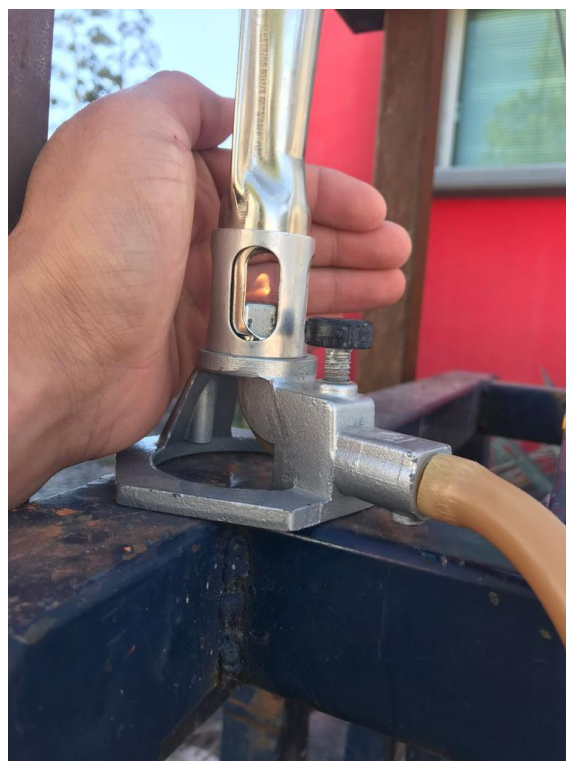
Figura 14. Comprobación física de obtención de gases de pirólisis.
