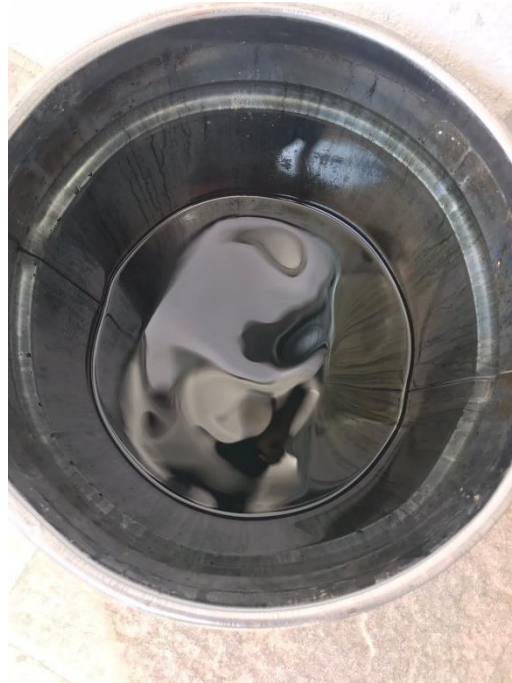
Figura 15. Comprobación física de combustible líquido bruto obtenido directamente de la condensación en el 1er recipiente: corrida 3.
