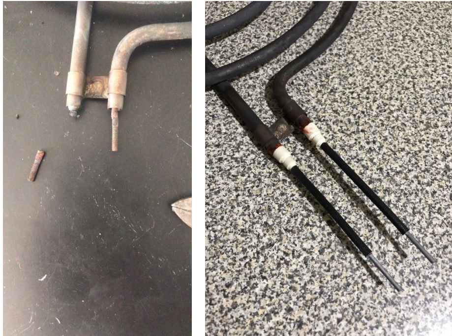
Figura 20. Subsanado de resistencias eléctricas.
