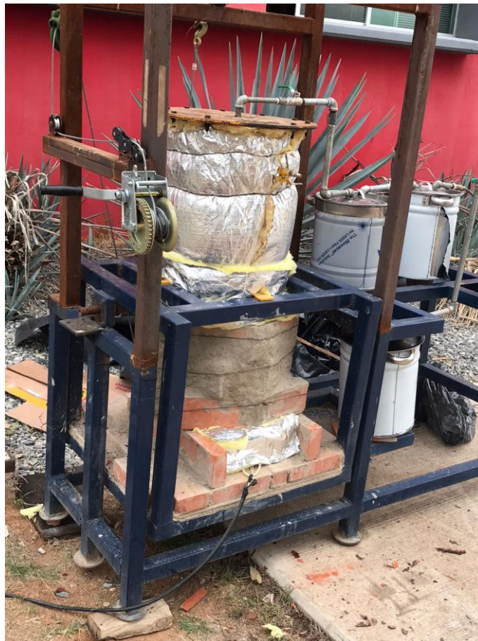
Figura 7. Reactor de pirólisis de estudio.
