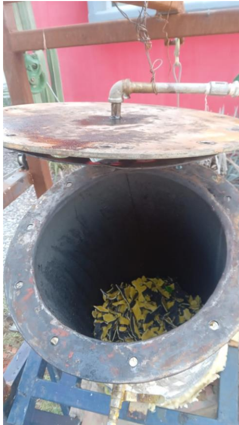
Figura 11. Materia prima en el reactor.
