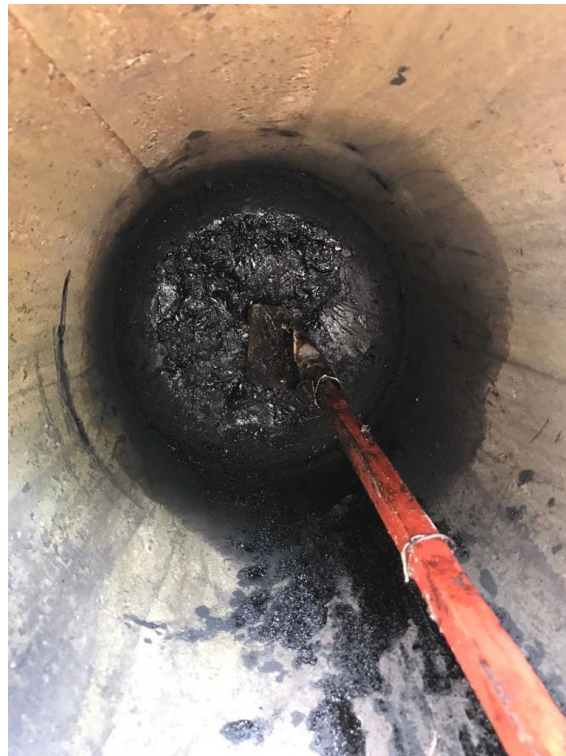
Figura 16. Comprobación física de residuos carbonizados obtenidos directamente de la pirólisis de la corrida 1.
