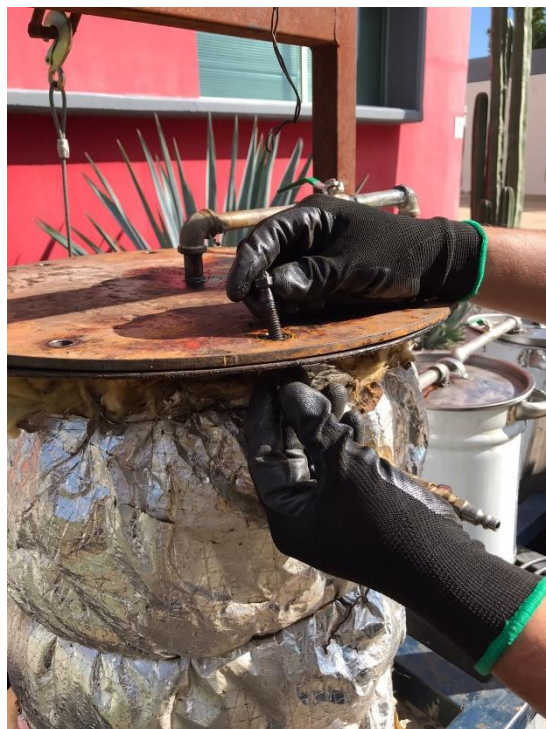
Figura 12. Cierre de reactor para iniciar prueba.
