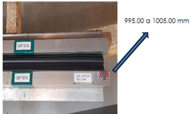
Ilustración 33 Longitud Cortada el Perfil
