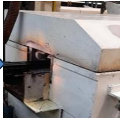
Ilustración 20 Entrando Material al Horno
