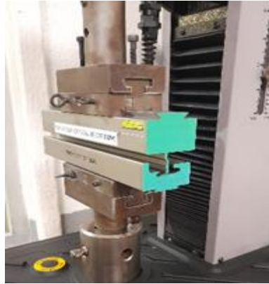
Ilustración 39 Fixtures de Extracción
