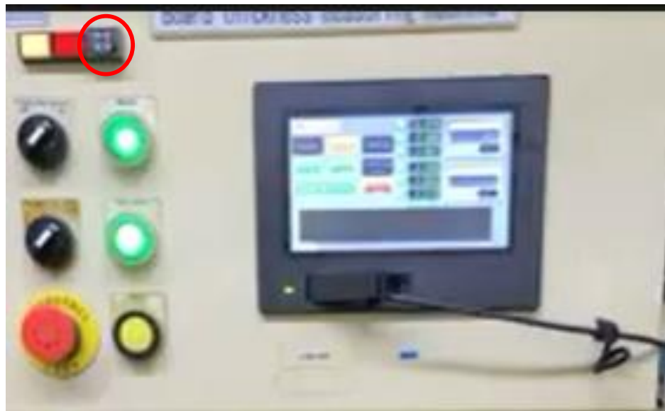
Figura 15. Buzzer (se señala en círculo rojo) se activa cuando se presenta una avería en el equipo.
