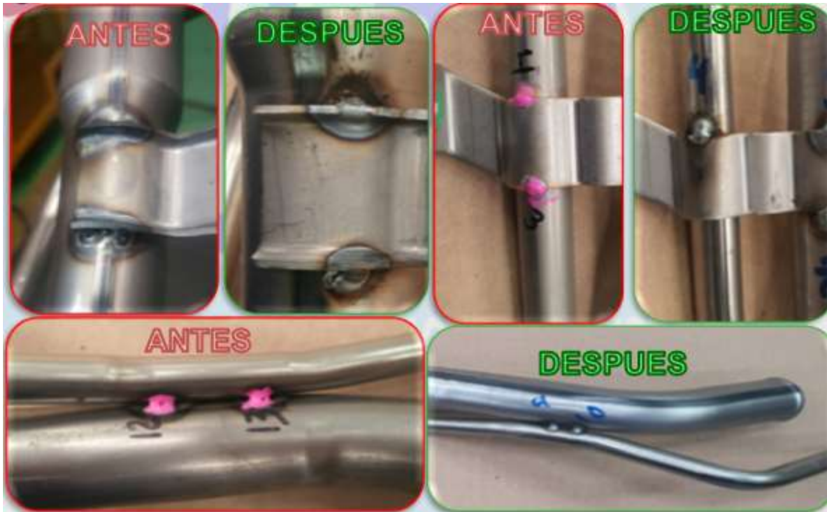
Ilustración 40 Piezas con modificación en puntos de soldadura
