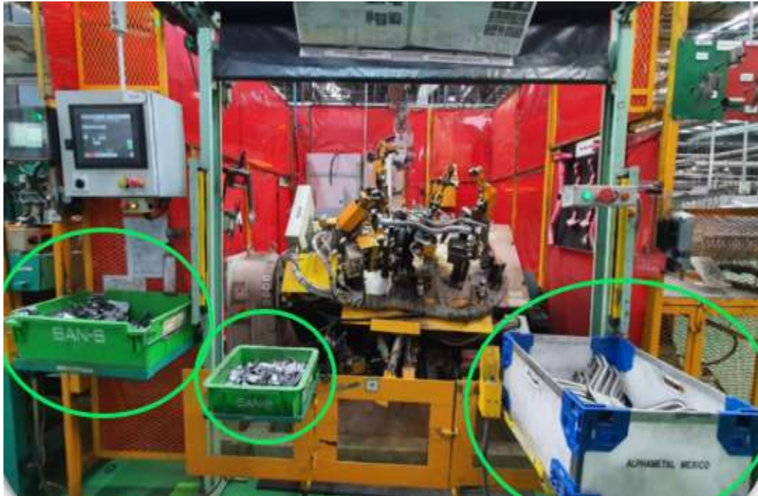
Ilustración 43 Robot con bases para componentes
