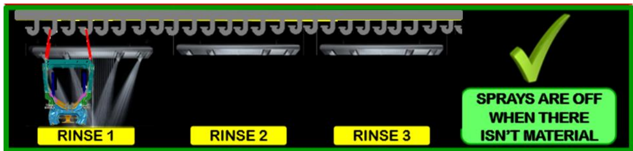
Ilustración 2. 9. Esquema del proceso de enjuagues automatizados. Fuente: YMEX 2023
